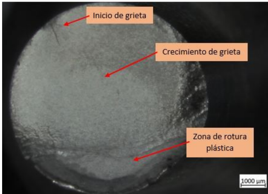
Figura 58. Caracterización de la sección de rotura plástica por fatiga.
