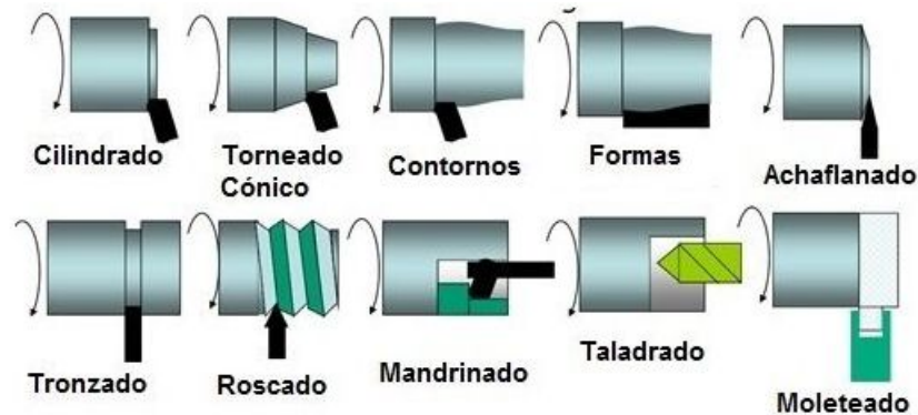
Figura 3. Operaciones de torneado [19].
