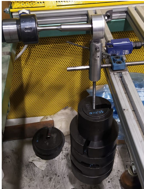
Figura 36. Colocación de la carga en el ensayo a fatiga.
