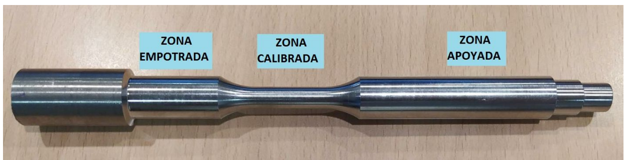
Figura 13. Zona empotrada, calibrada y apoyada de las probetas.
