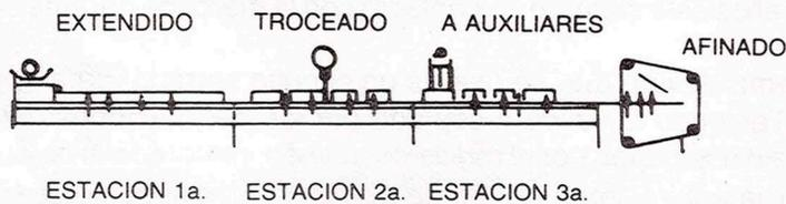
Fig. 3. Esquema de mesa con aerosuspensión
