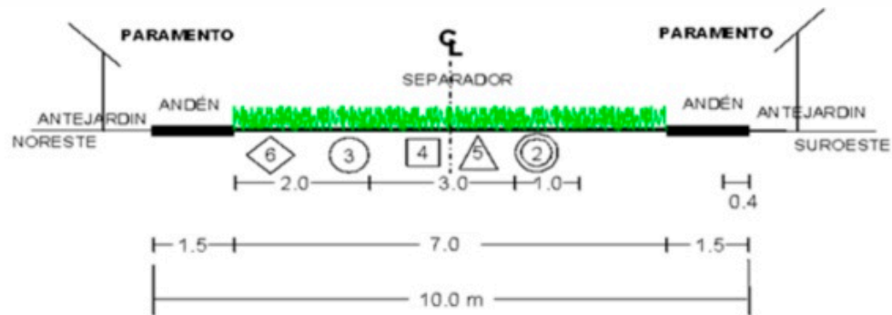
Figura 35. Canalización de las redes de servicios públicos zona verde central. Tomado de Empresas Públicas de Medellín.
