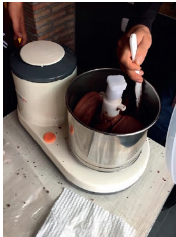
Figura 41. Molino refinador de cacao. Fuente: Leidy Machado Cuellar.
