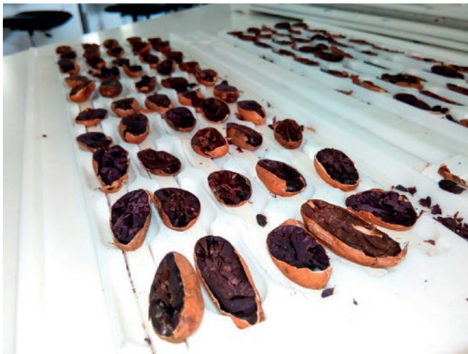
Figura 32b. Corte de granos realizados con guillotina. Fuente: Joserth Sánchez Cerquera.
