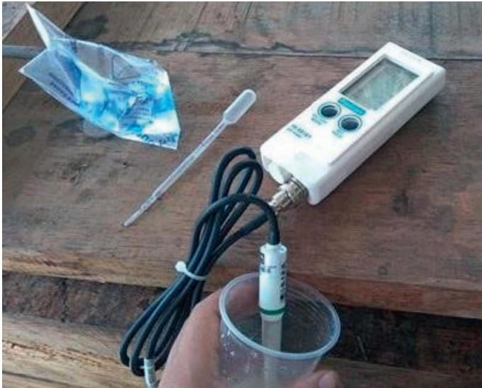
Figura 21. Potenciómetro utilizado para la medición de pH en masa de fermentación de cacao. Fuente: Leidy Machado Cuellar.
