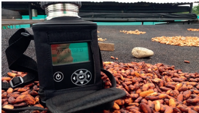
Figura 24b. Medición de la humedad del grano de cacao seco. Fuente: Leidy Machado Cuellar y Joserth Sánchez Cerquera.
