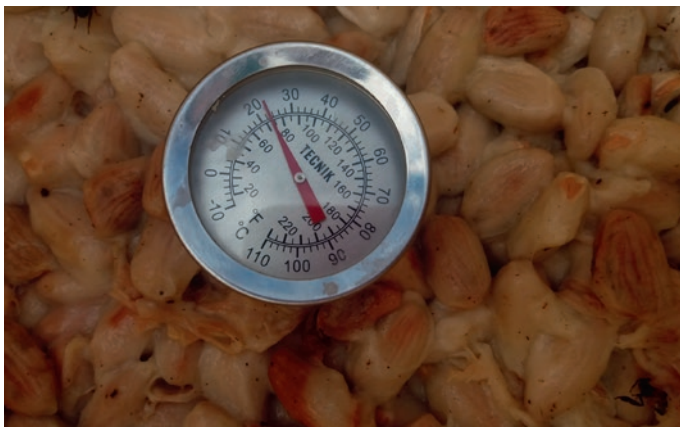
Figura 19a. Termómetro de punzón utilizado para la medición de temperatura en la parte superficial de la masa de fermentación. Fuente: Leidy Machado Cuellar y Joserth Sánchez Cerquera.
