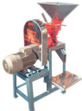
Figura 40. Equipo utilizado para la separación de la cáscara de los granos de cacao de los nibs. Fuente: Dora Barbosa.
