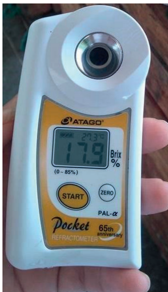
Figura 20a. Refractómetro digital utilizado para la medición de grados Brix en granos de cacao. Fuente: Leidy Machado Cuellar. .....
