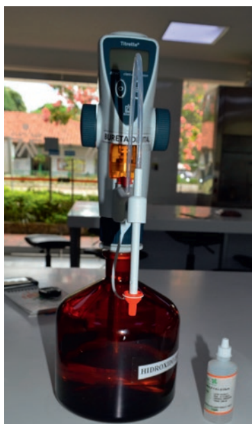
Figura 22. Método para determinar la acidez titulable en granos de cacao. Fuente: Leidy Machado Cuellar.
