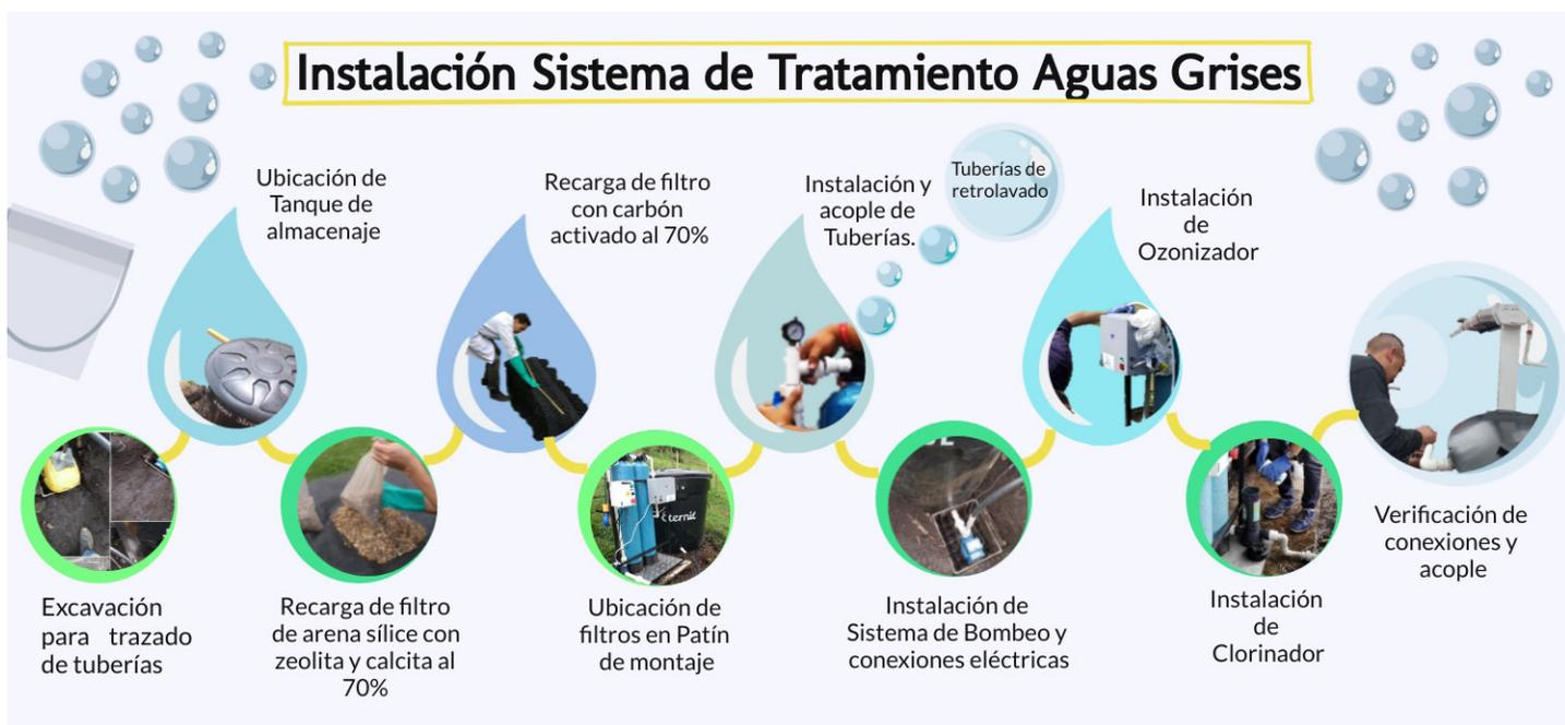
Figura 9. Procedimiento de implementación de sistemas de tratamiento de aguas grises.
