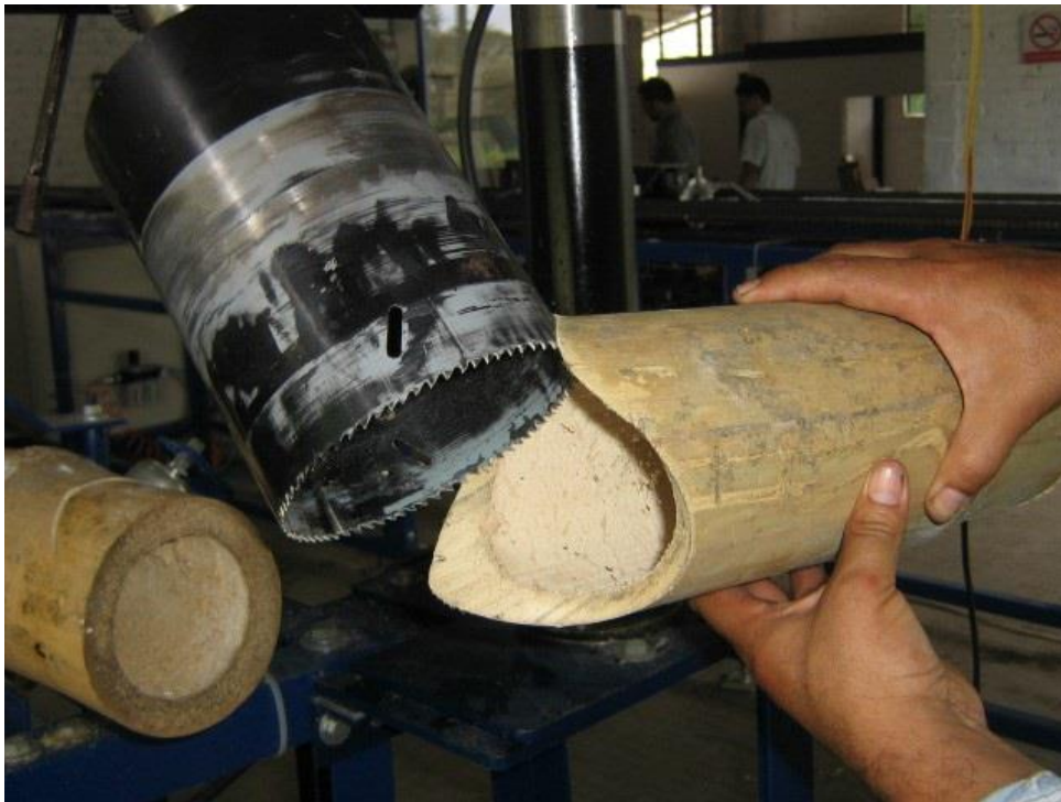
Figura 28. Cortes en boca de pescado para Guadua
