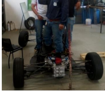
Figura 46. Simulación de carga estática en el vehículo
