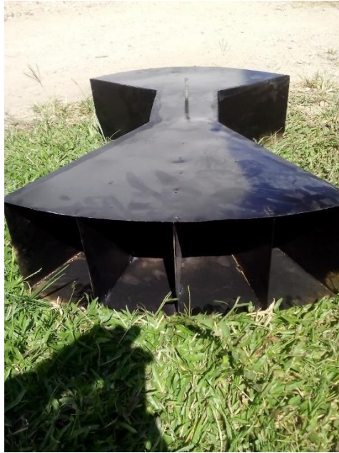
Foto 4: Vista frontal de la maqueta. En esta foto se evidencia la ausencia de una malla frontal que proteja contra residuos y/o peces. En la parte superior está el eje que encaja con el mecanismo del generador eléctrico que va ubicado sobre sistema de flotación (tipo barcaza)
