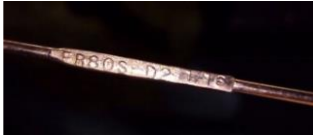
Figura 44. Material de aporte soldadura TIG
