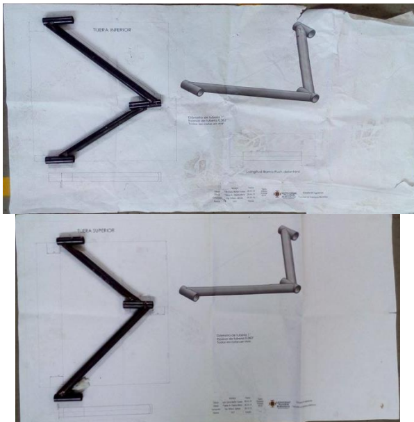
Figura 43. Presentación de la tijera sobre el plano de fabricación
