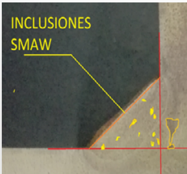
Figura 9 Macrografía filete con proceso SMAW a 50X Fuente: autores del proyecto
