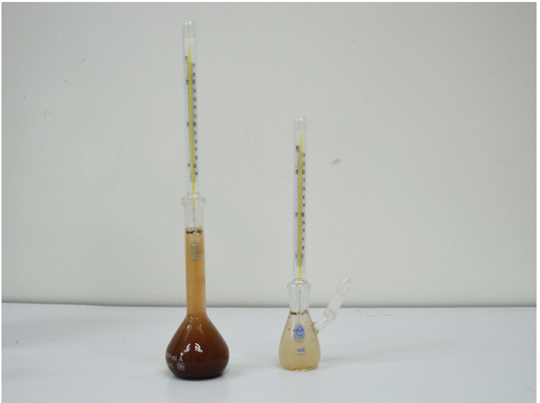
Figura 11. Método del picnómetro para determinación de la densidad real. Fuente: Leidy Machado.
