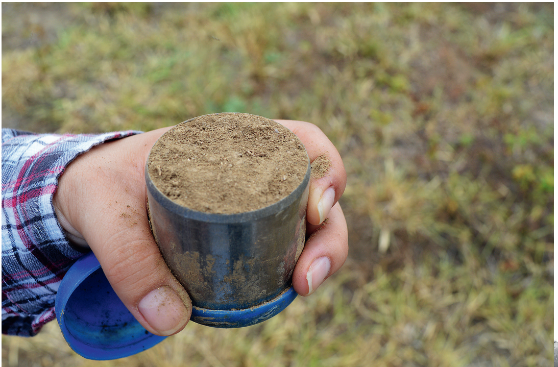
Figura 10. Método de cilindro para determinación de densidad aparente. Fuente: Leidy Machado.
