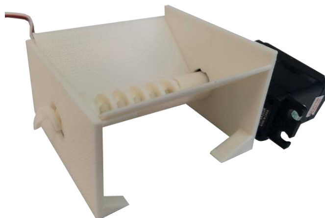
Figura 31. Sistema de alimentación desarrollado para el molino ultracentrífugo.
