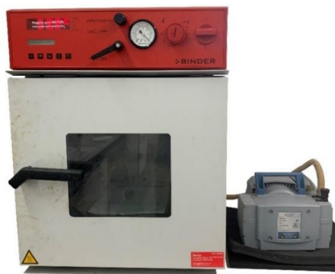
Figura 33. Estufa de vacío Binder APT VD23 (izquierda) y bomba de vacío (derecha)
