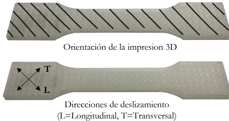
Figura 182. Esquema de una probeta con la orientación de la impresión 3D y las direcciones de deslizamiento
