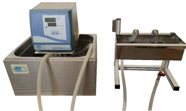
Figura 40. Baño atemperado formado por un sistema de recirculación de agua (izquierda) y una bañera (derecha).
