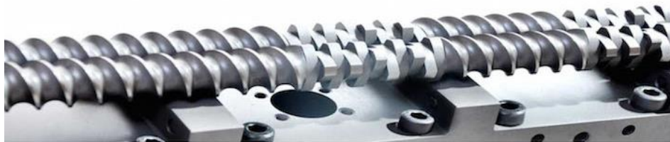
Figura 38. Configuración de doble husillo corrotante.
