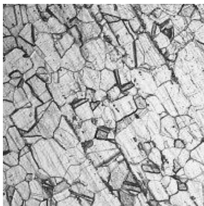
Figura 27. Microestructura del acero AISI 316L (10x).
