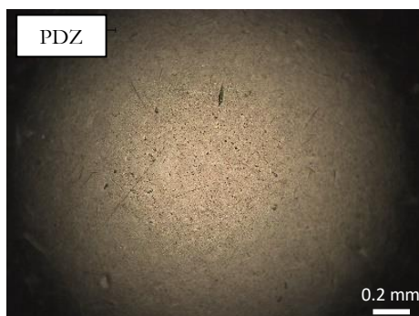
Figura 174. Micrografía óptica de la bola de acero tras el ensayo realizado sobre el PDZ.
