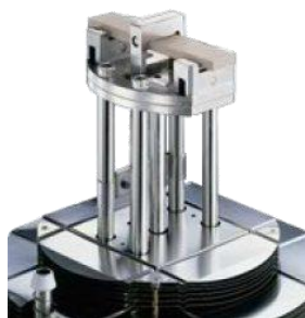
Figura 86. Configuración a flexión en tres puntos
