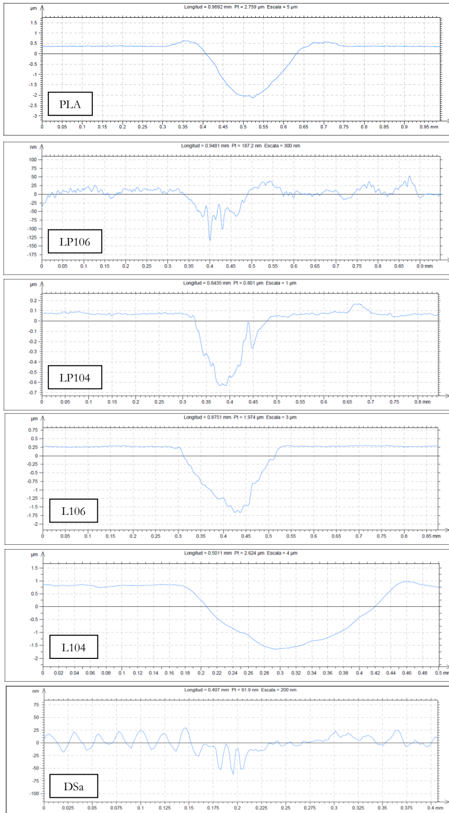
Figura 135. Perfiles transversales de las huellas de los ensayos de deslizamiento lineal oscilatorio con lubricación externa (nótese la escala en nanómetros para LP106 y DSa).
