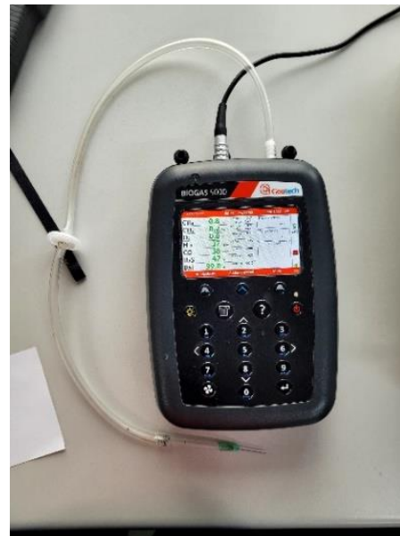
Figura D: Analizador de biogás BIOGAS 5000 de Geotec. Fuente: Elaboración propia.
