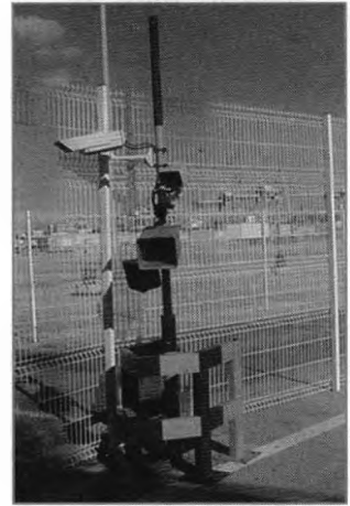
Sistema SIAM (de identificación automática de matrículas para coches embarcados).
