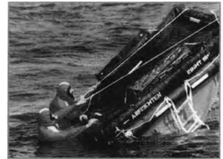
Volteo de una balsa aprovechando el viento y apoyados en la botella de gas de inflado.
