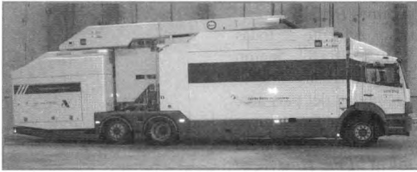
Equipo de inspección de rayos X según CSI. Fuente: Autoridad Portuaria Bahía de Algeciras (APBA)
