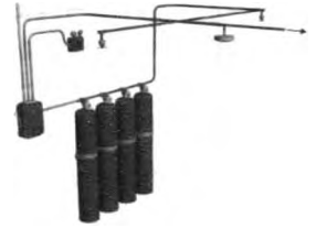
Sistema combinado aunque independiente, de detección, alarma y extinción de incendios de forma automática.
