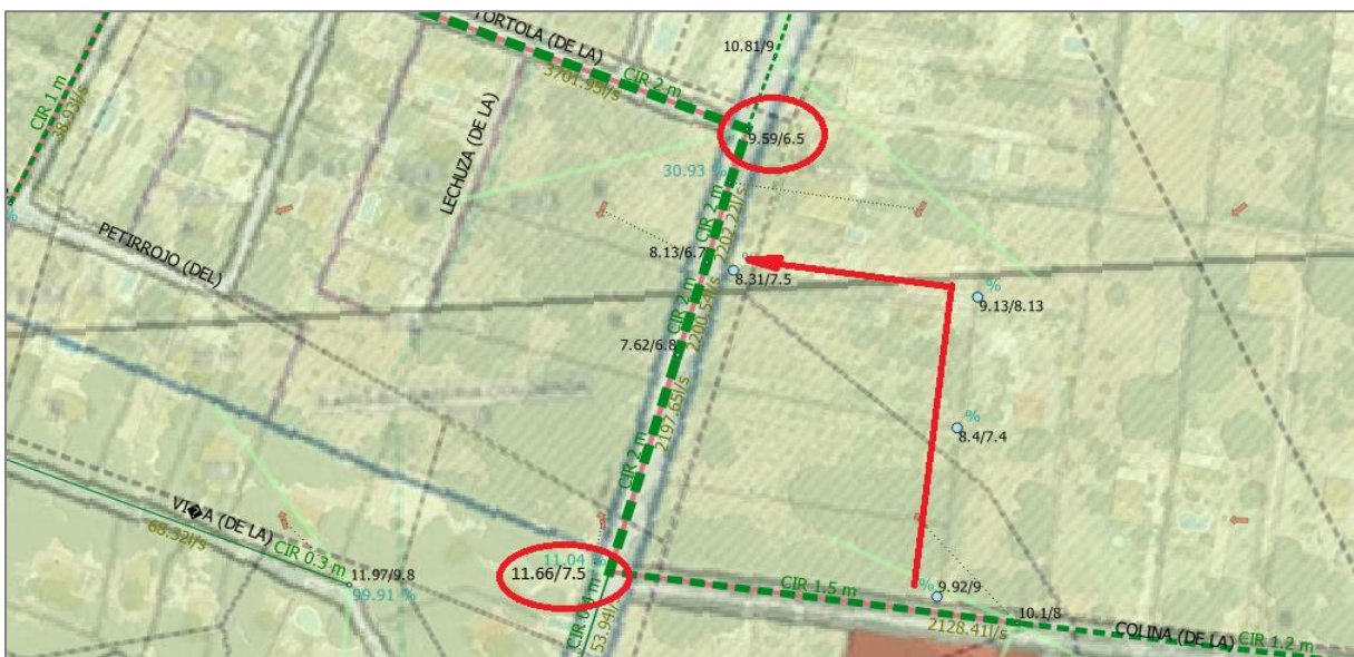
Figura 18: Esquema de planteamiento de mejoras de la red de pluviales en camino de la Colina, camino del Pinar de los Franceses y camino de la Tórtola.
