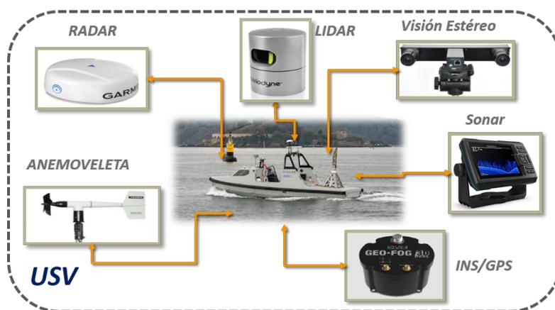
Figura 1.4. Sensores utilizados para conocer el estado del buque y el entorno que lo rodea.
