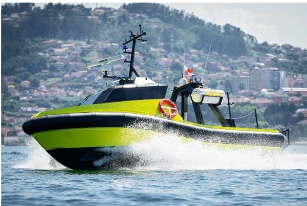
**Figura 2.1.** USV Vendaval del Puerto de Ceuta, primer vehículo marino de superficie no tripulado que opera en España [78].
