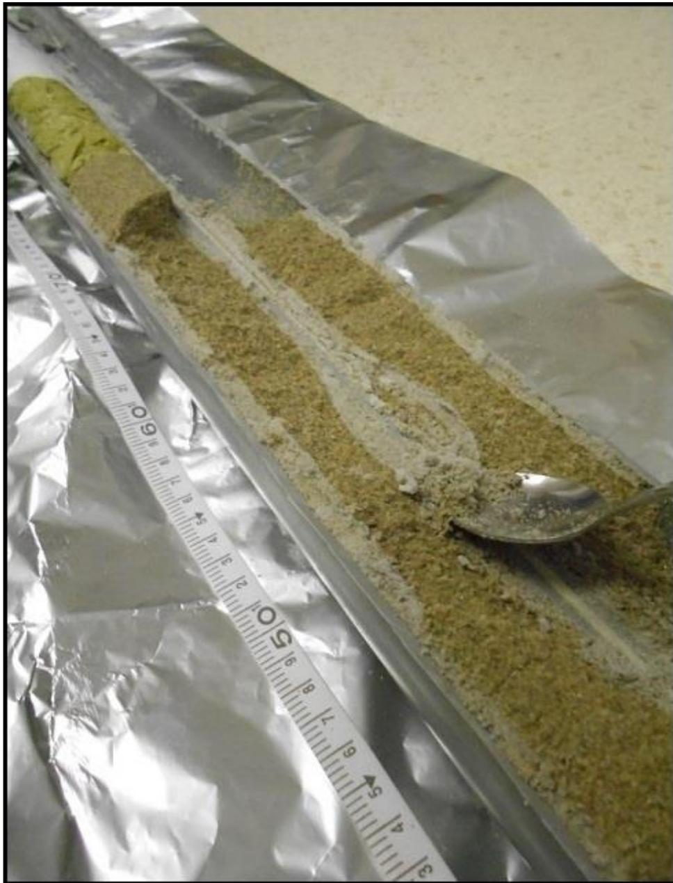
Fig. 4.2 Toma de muestras cada 10 cm de uno de los cores de 1 m de longitud
