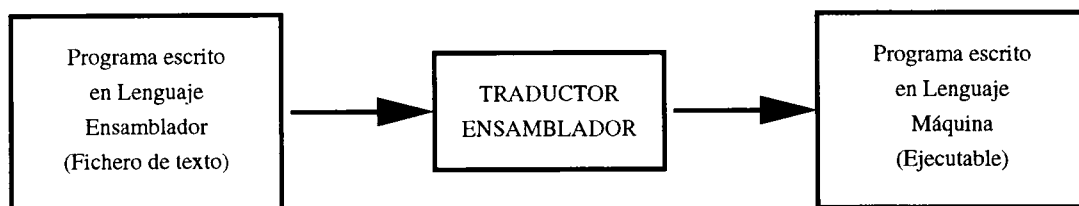
Figura 6.2: Paso de Ensamblador a Lenguaje Máquina.
