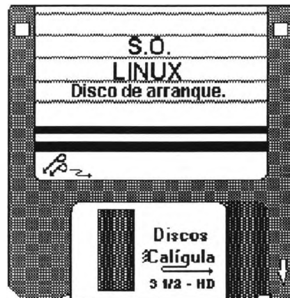
Figura 2.20: Disco flexible de 3\frac{1}{2} pulgadas y alta densidad, el cual tiene 1.44 MegaBytes en sus 2880 sectores.
