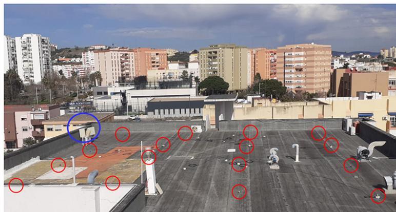
Figura 5.18: Red de sensores WiFi desplegada en la azotea del edificio. Los círculos rojos indican la ubicación de los piranómetros, el círculo azul ubica la posición de las fuentes de alimentación y el router.
