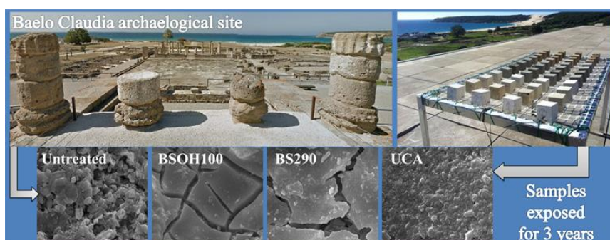
Figura 4. Evaluación de la durabilidad in-situ de un producto hidrofugante. Imagen tomada de [24].
