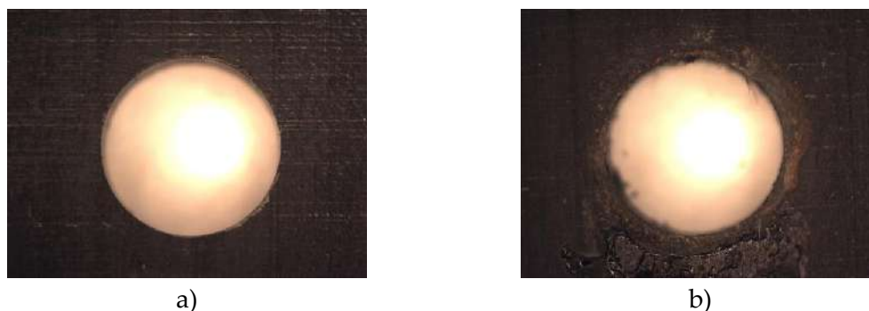
Figura 4.82. Intercara en el fresado helicoidal de Ti/CFRP; a) CFRP agujero número 1; b) CFRP agujero número 8.
