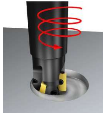
Figura 2.26. Representación del proceso fresado helicoidal.
