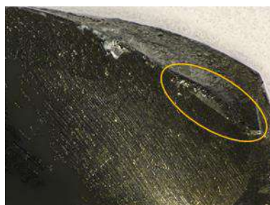
Figura 4.27. Imagen de la pérdida de material de uno de los filos de corte de la herramienta empleada en el fresado helicoidal de la aleación de titanio con los parámetros de mecanizado V_c=160 m/min, f_z=0.003 mm/diente y f_{za}=0.001 mm/diente.
