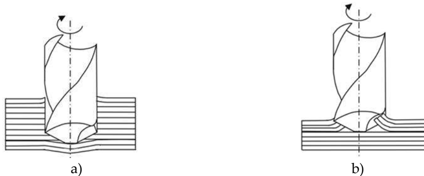
Figura 2.21. Esquema de delaminación. a) En la entrada del agujero. b) En la salida del agujero.
