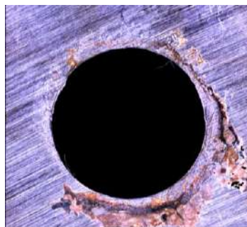
Figura 4.84. Salida del agujero 8 en la aleación de titanio en el fresado helicoidal del stack Ti/CFRP.
