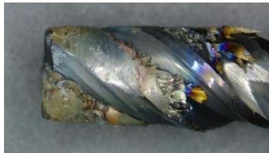
Figura 4.7. Herramienta empleada en el ensayo de fresado helicoidal de la aleación Ti6Al4V con los parámetros de corte: V_c = 160 \text{ m/min} , f_{z1} = 0,015 \text{ mm/diente} , f_{z2} = 0,001 \text{ mm/diente} .
