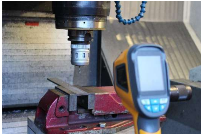
Figura 3.11. Sujeción de la probeta mediante mordaza hidráulica
