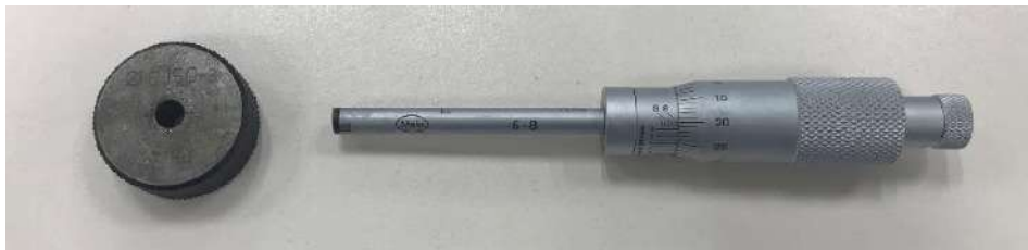
Figura 3.15. Micrómetro de interiores de tres contactos (rango 6-8 mm) junto con anillo patrón.
