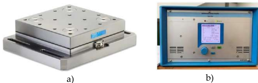
Figura 3.31. a) Mesa dinamométrica Kistler 9255B. b) Amplificador Kistler 5070A.
