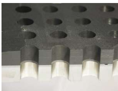
Figura 1.5. Ejemplo de estructura híbrida material compuesto/metal.
