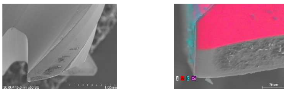
Figura 4.60. Imágenes SEM-EDS de uno de los fillos de la herramienta empleada en el fresado de CFRP.
