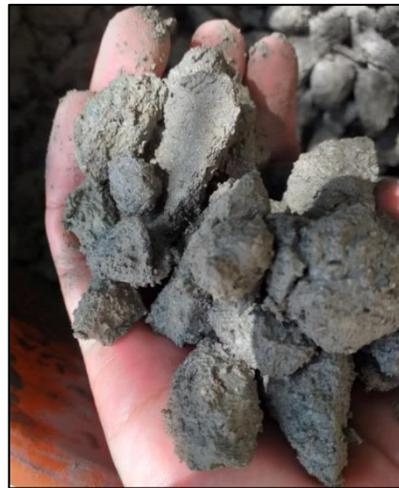
**Proceso de homogenización de los materiales por tanda en la mezcla con 10% PVM**
