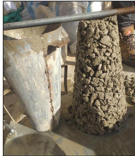
**Slump 0" – Diseño de Mezcla con 30% PVM**
