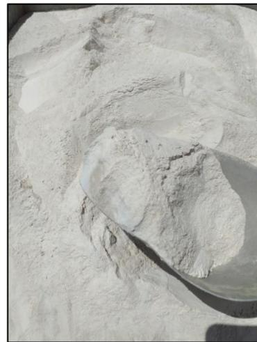
**Vidrio Molido de 0.15mm a utilizar en la elaboración del Diseño de las Muestras**
