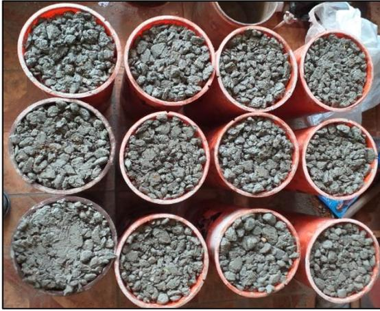
**Moldes cilíndricos de 6"x12" con concreto permeable – Diseño con 0%PVM**
