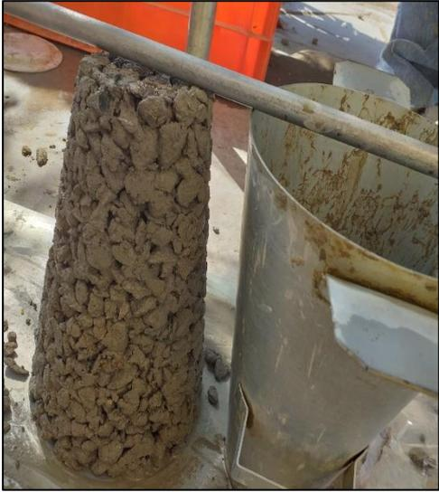
**Slump 0" – Diseño de Mezcla con 0% PVM**
