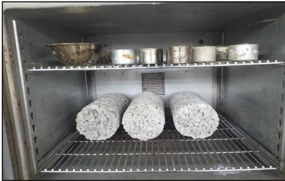
**Muestras húmedas colocadas al horno por 24 horas.**
