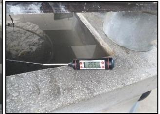
**Calculo el tamaño del accesorio adicional al gancho; probeta sumergida y oxigenación de esta; peso de probeta sumergida con accesorio al gancho; toma de temperatura del conjunto.**
