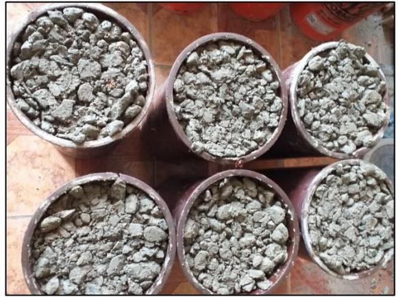
**Moldes cilíndricos de 6"x12" con concreto permeable – Diseño con 10%PVM**
