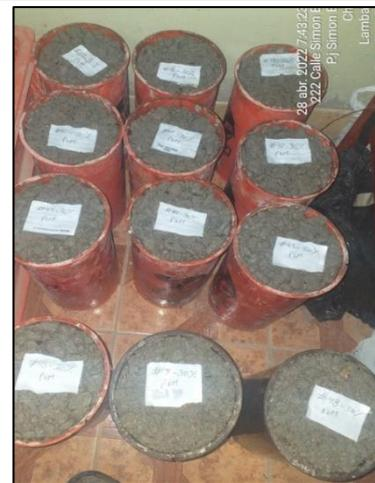
**Moldes cilíndricos de 6"x12" con concreto permeable – Diseño con 30%PVM**
