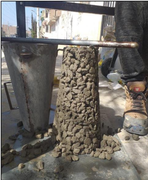
**Slump 1/2" – Diseño de Mezcla con 15% PVM**
