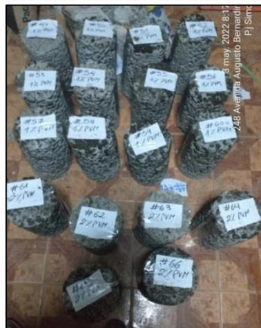
**Moldes cilíndricos de 6"x12" con concreto permeable – Diseño con 1 y 2%PVM**
