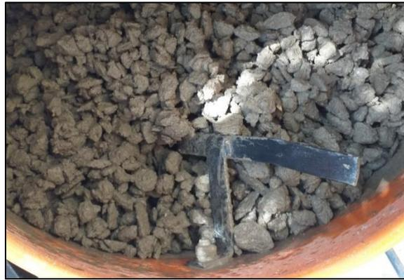
**Proceso de homogenización de los materiales por tanda en la mezcla con 0% PVM**
