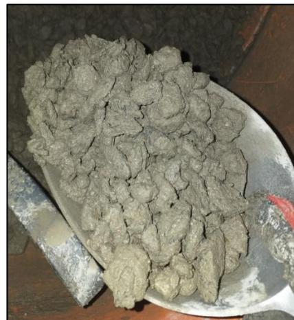
**Proceso de homogenización de los materiales por tanda en la mezcla con 15% PVM**
