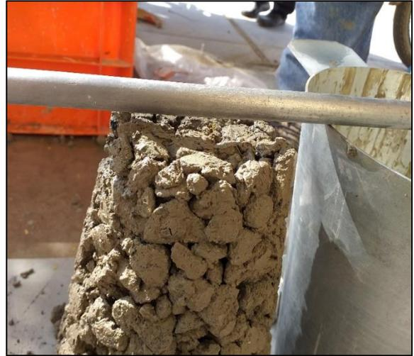
**Slump 1/2" – Diseño de Mezcla con 10% PVM**
