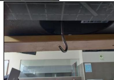
**Desnivel armado con ayuda de otros instrumentos; nivelación y colocación del gancho de balanza.**
