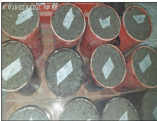
**Moldes cilíndricos de 6"x12" con concreto permeable – Diseño con 15%PVM**
