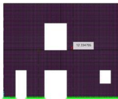
Fig. 9. Distribución de esfuerzos ante sismo dinámico en dirección Y, en estructura sin reforzamiento. Esfuerzo S23(Tn/m 2 ) SAP2000
