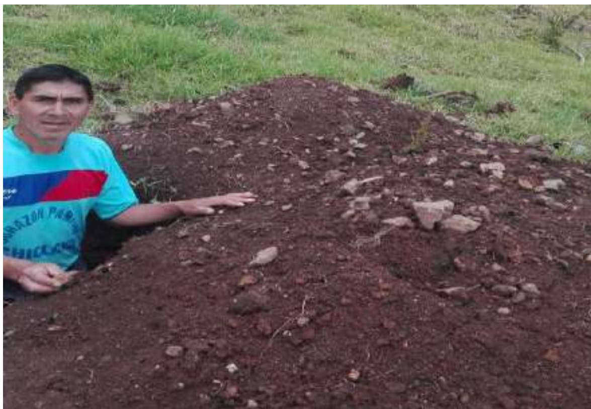
Imagen N° 2.24: Extracción de muestras, calicatas a cielo abierto
