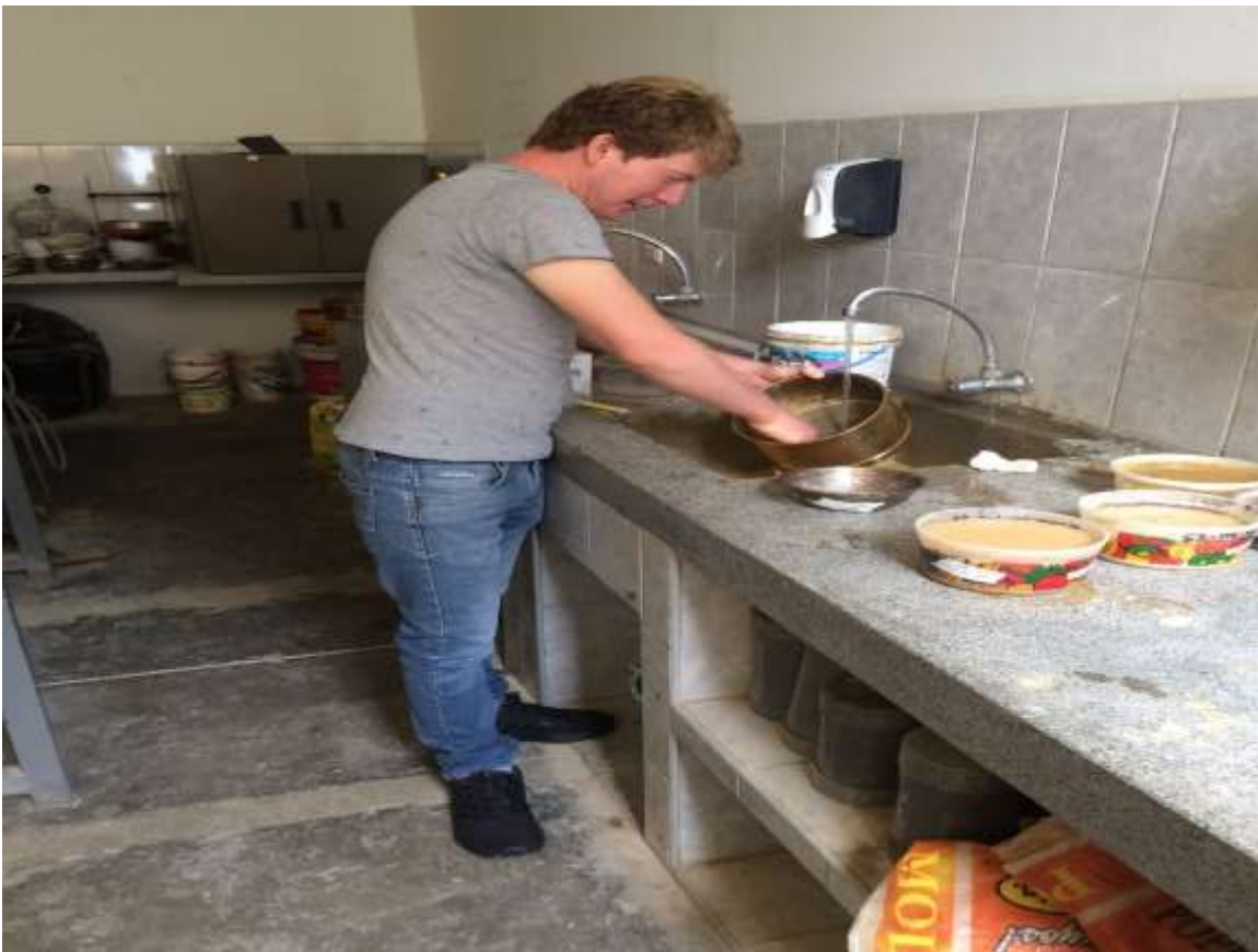
Imagen N° 2.27: Lavado de muestras en tamiz N° 200 para realizar ensayo de granulometría
