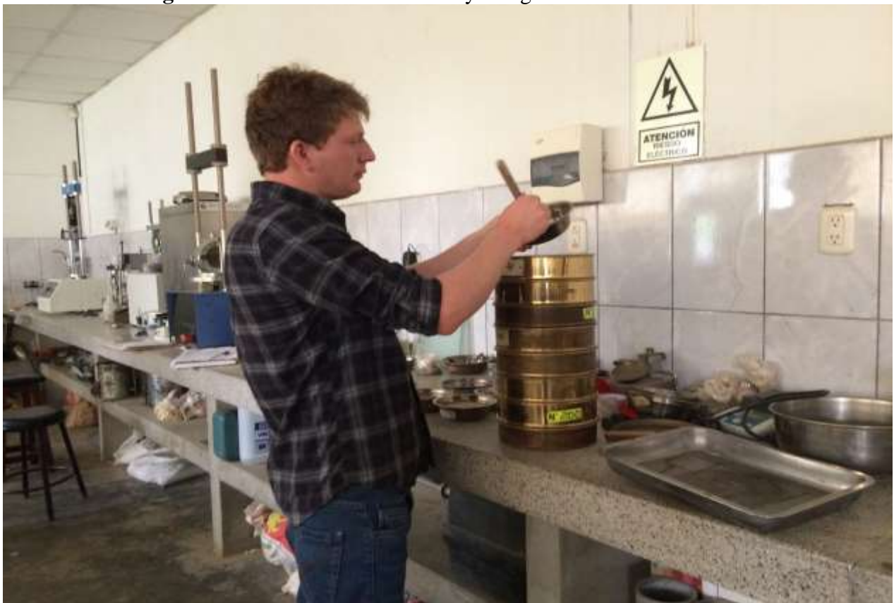
Imagen N° 2.29: Realización de ensayo de granulometría de suelos
