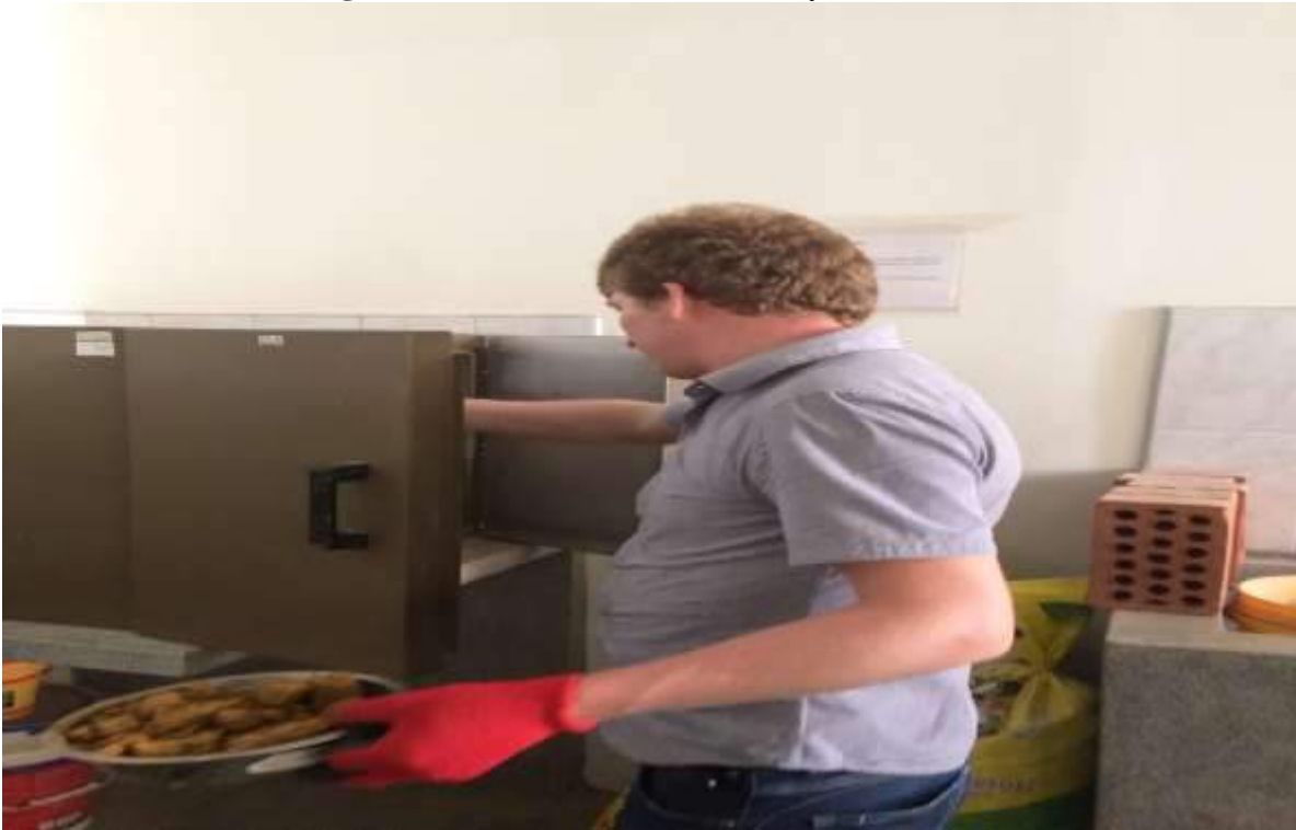
Imagen N° 2.28: Realización de ensayo de humedad
