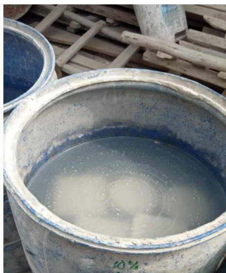
Imagen 16: Inmersión de probetas en agua. Fuente: Elaboración Propia.
