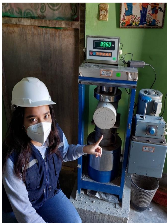
Imagen 72: Ensayo a la Tracción al 10% a los 14 días. Fuente: Elaboración Propia.
