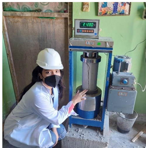
Imagen 18: Ensayo de resistencia a la compresión. Fuente: Elaboración Propia.
