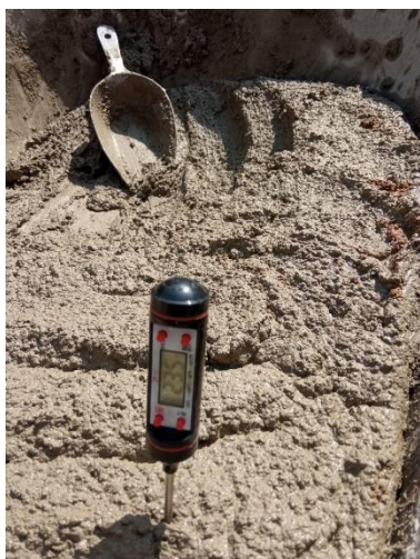
Imagen 05: Temperatura de la mezcla. Fuente: Elaboración Propia.
