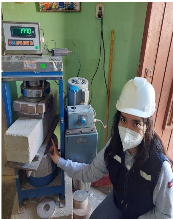
Imagen 73: Resistencia a la Flexión en vigas a 28 días. Fuente: Elaboración Propia.
