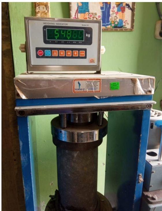
Imagen 65: Resistencia a la Compresión a 7 días. Fuente: Elaboración Propia.
