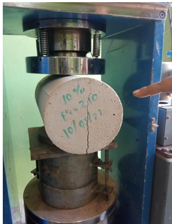
Imagen 66: Ensayo a la Tracción al 10% a los 7 días. Fuente: Elaboración Propia.
