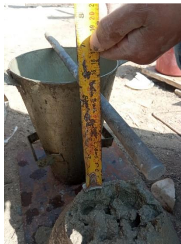
Imagen 06: Ensayo de Cono de Abrams Fuente: Elaboración Propia.
