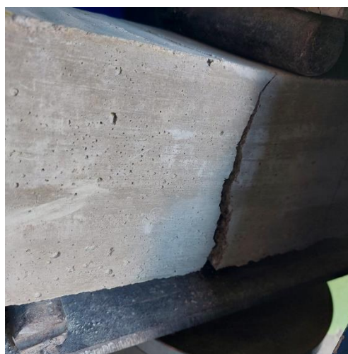
Imagen 20: Rotura de viga en ensayo. Fuente: Elaboración Propia.
