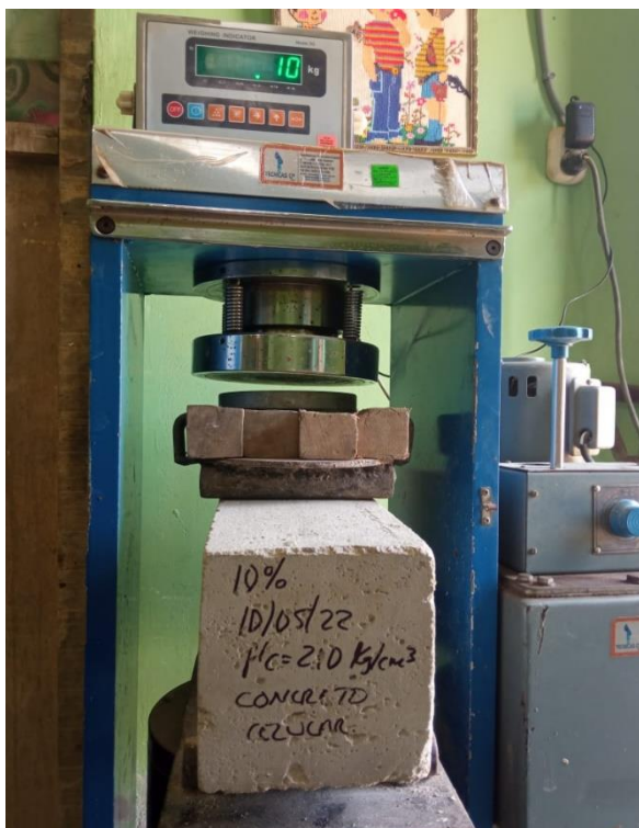
Imagen 67: Resistencia a la Flexión en vigas a 7 días. Fuente: Elaboración Propia.
