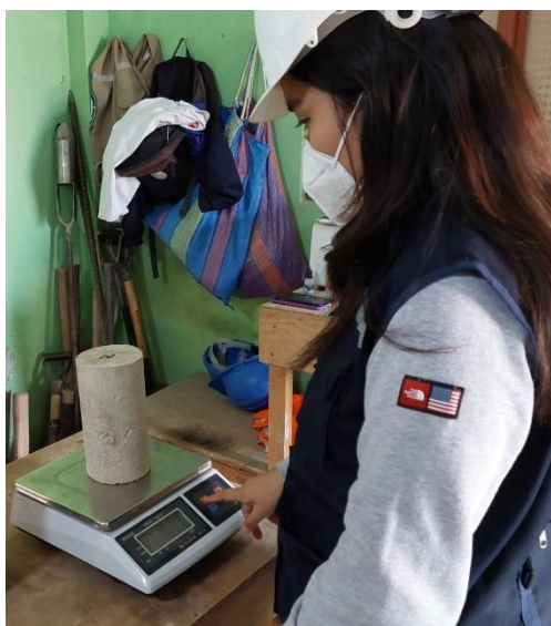
Imagen 15: Peso de la probeta seca. Fuente: Elaboración Propia.
