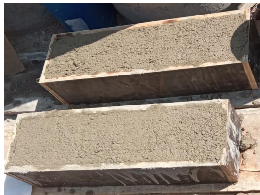
Imagen 14: Vigas con la muestra. Fuente: Elaboración Propia.
