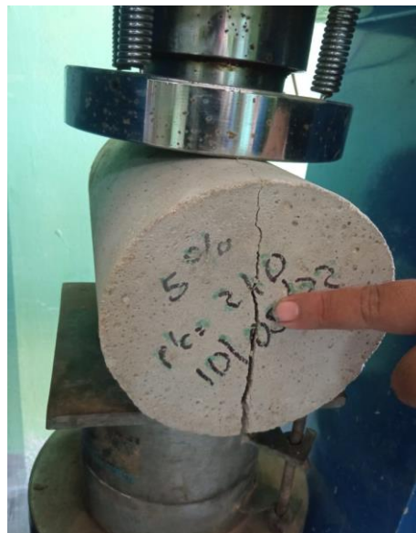
Imagen 22: Rotura por Tracción. Fuente: Elaboración Propia.
