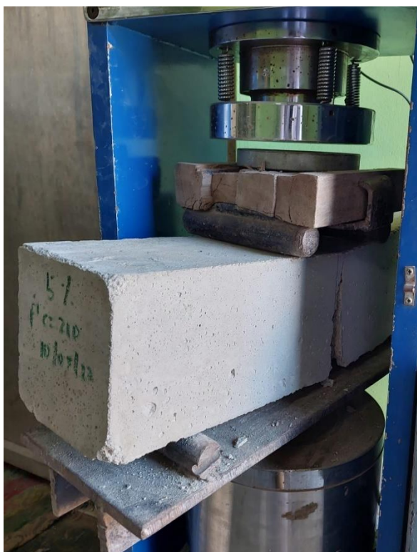
Imagen 71: Resistencia a la Flexión en vigas a 14 días. Fuente: Elaboración Propia.
