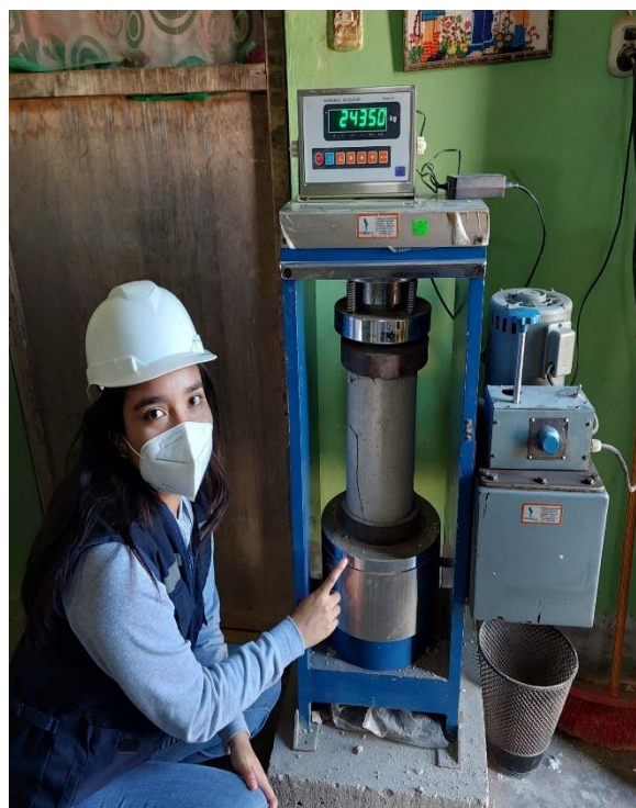
Imagen 74: Ensayo de Resistencia a Compresión a 28 días. Fuente: Elaboración Propia.
