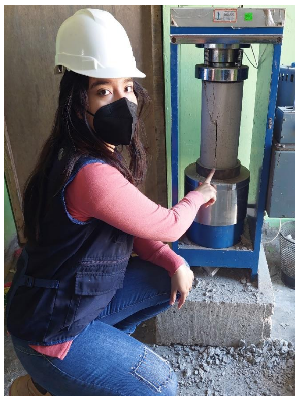
Imagen 70: Ensayo a la Compresión a los 14 días. Fuente: Elaboración Propia.
