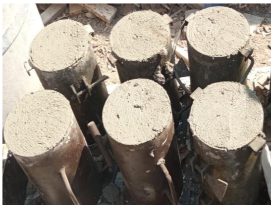
Imagen 13: Probetas cilíndricas con la muestra. Fuente: Elaboración Propia.
