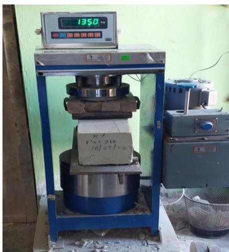
Imagen 19: Ensayo de flexión en vigas. Fuente: Elaboración Propia.
