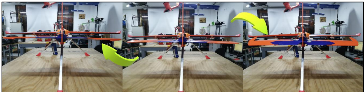
Figura 4.10. Movimiento del elevador [Autores].
