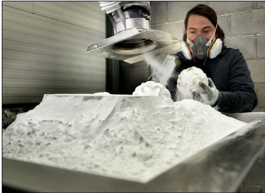
Figura 2.29. Impresión 3D SLS [47].
