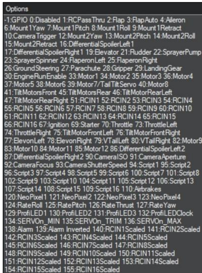
Figura 3.64. Opciones de configuración salidas PWM [Autores].
