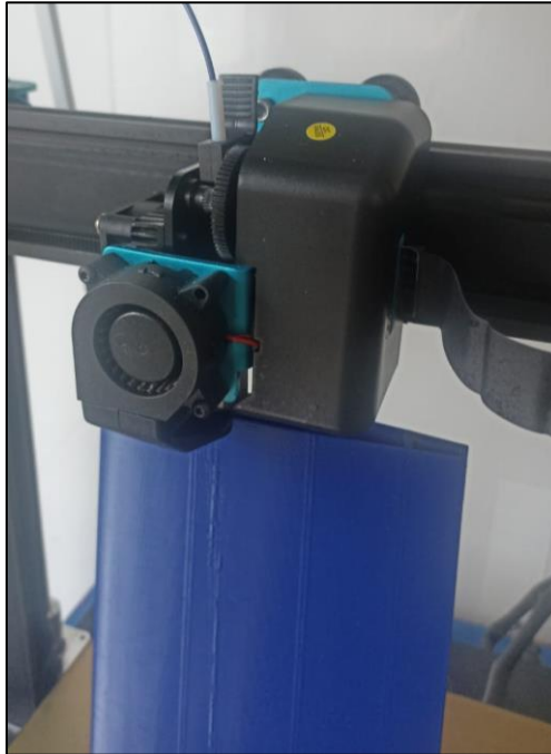
Figura 3.27. Impresión pieza raíz del ala [Autores].
