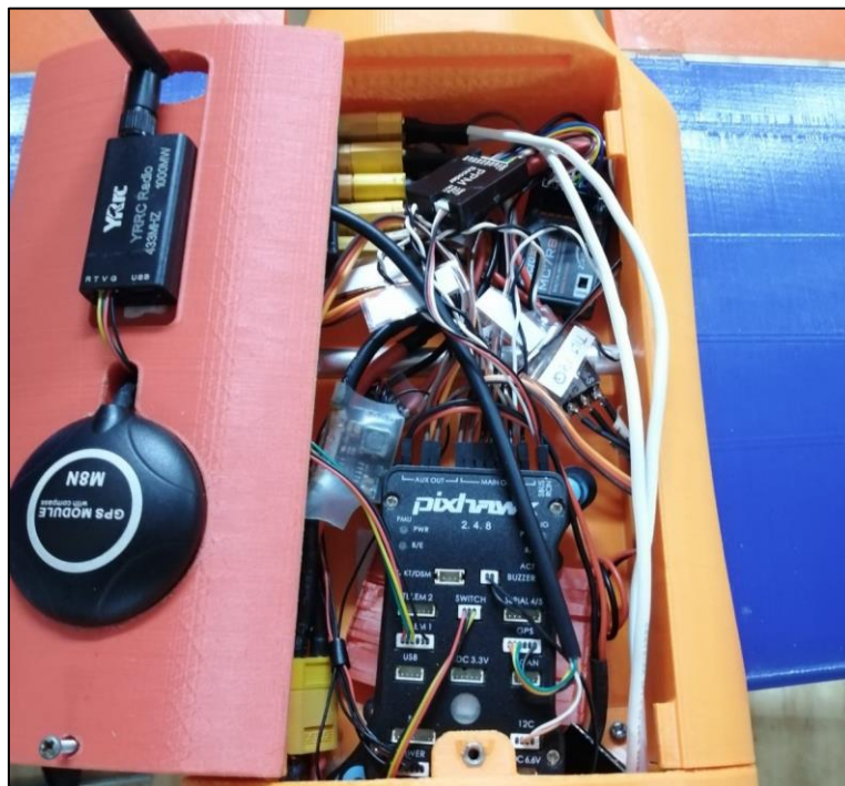
Figura 4.7. Autopiloto y cables dentro del fuselaje [Autores].
