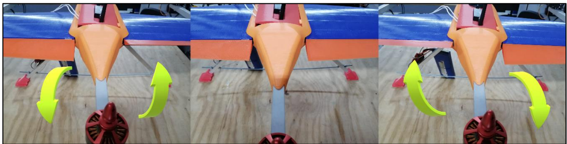
Figura 4.11. Movimiento de los alerones [Autores].
