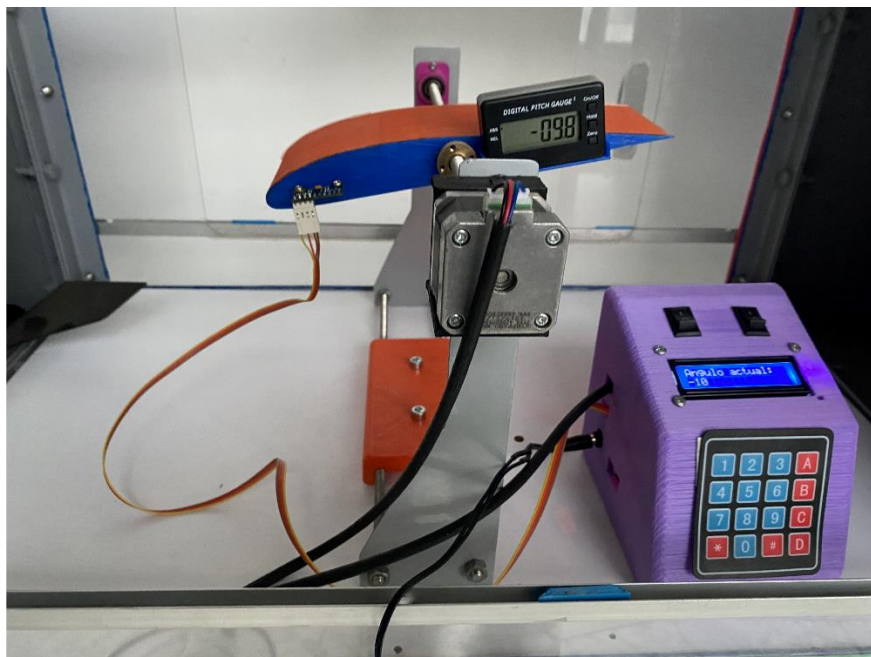
Figura 4.16. Banco de control de ángulo de ataque a -10^\circ . (Autores)
