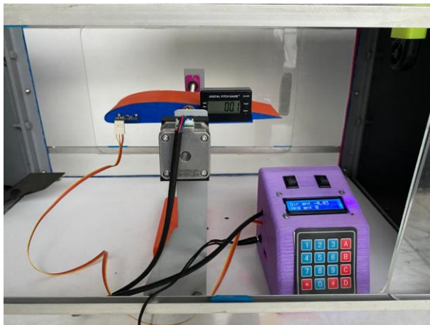
Figura 4.14. Banco de control de ángulo de ataque a 0^\circ . (Autores)
