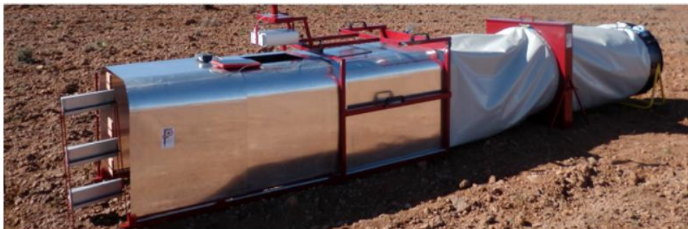
Figura 2.23. Patente túnel de viento para el estudio de la erosión eólica. (España Patente nº 07075909 .7, 2011)
