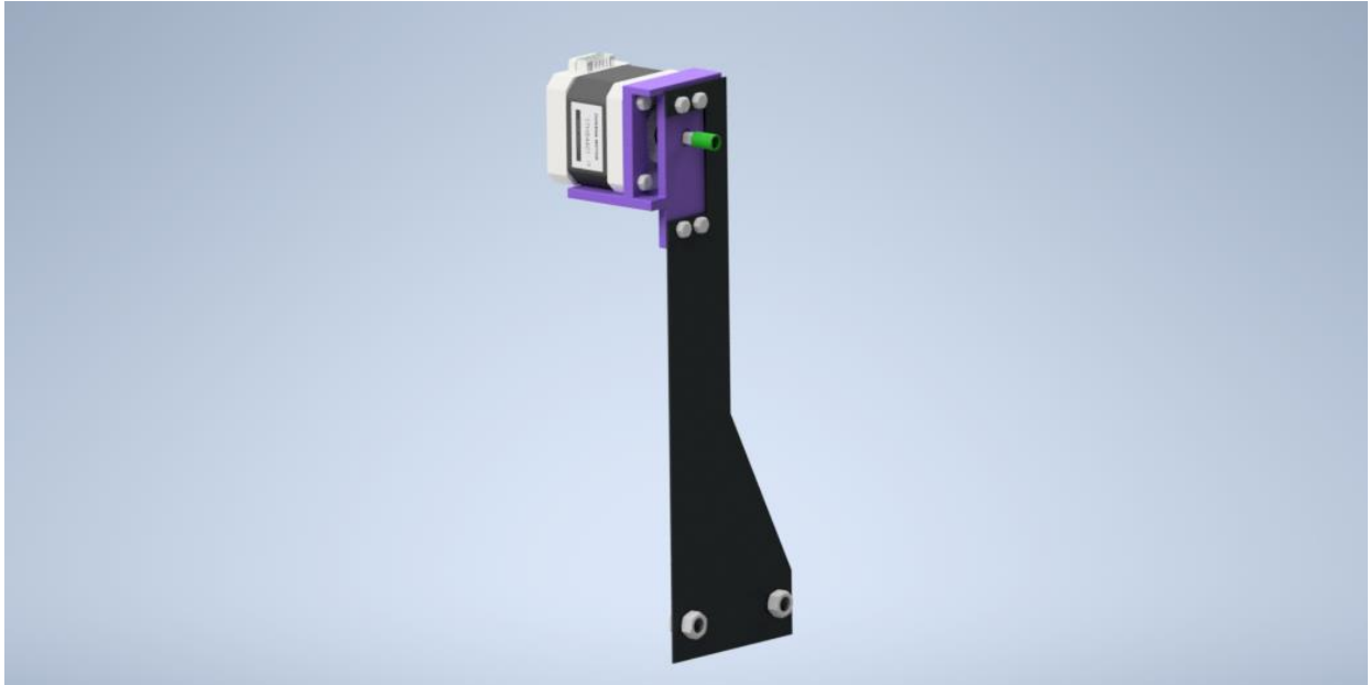
Figura 3.25. Ensamble de la placa con soporte del motor a pasos. (Autores)
