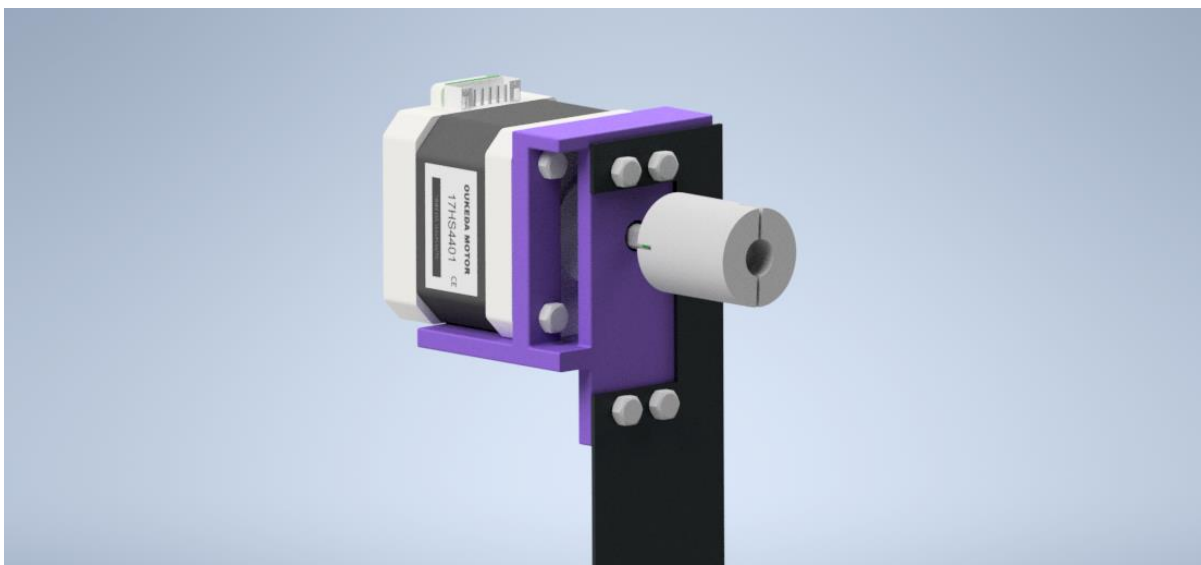
Figura 3.26. Ensamble soporte del motor a pasos con el acople. (Autores)
