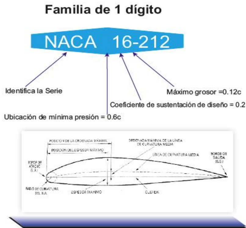
Figura 2.4. Perfil alar Naca 1 dígito. (Pinzón Paz, 2013)
