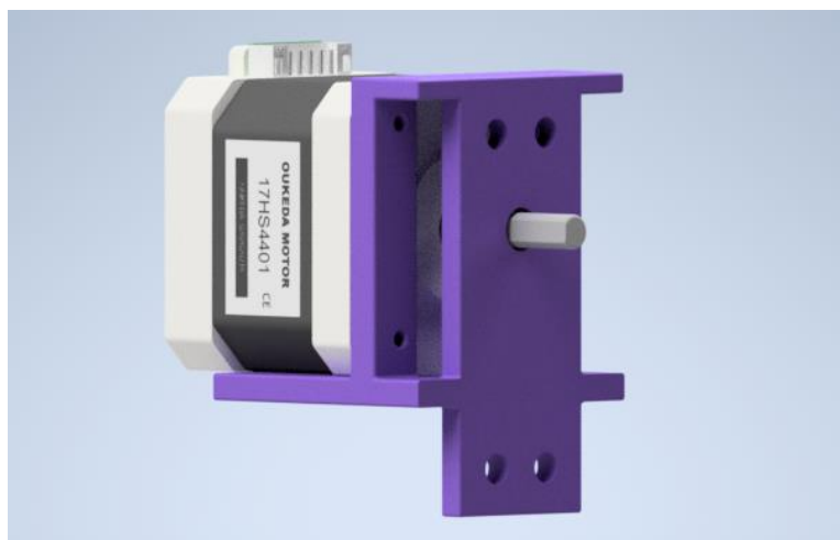
Figura 3.24. Ensamble motor a pasos con soporte. (Autores)
