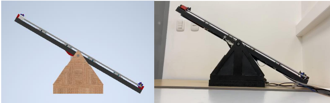
Figura 76. Comparación entre el diseño y la construcción del componente mecánico del módulo de plano inclinado
