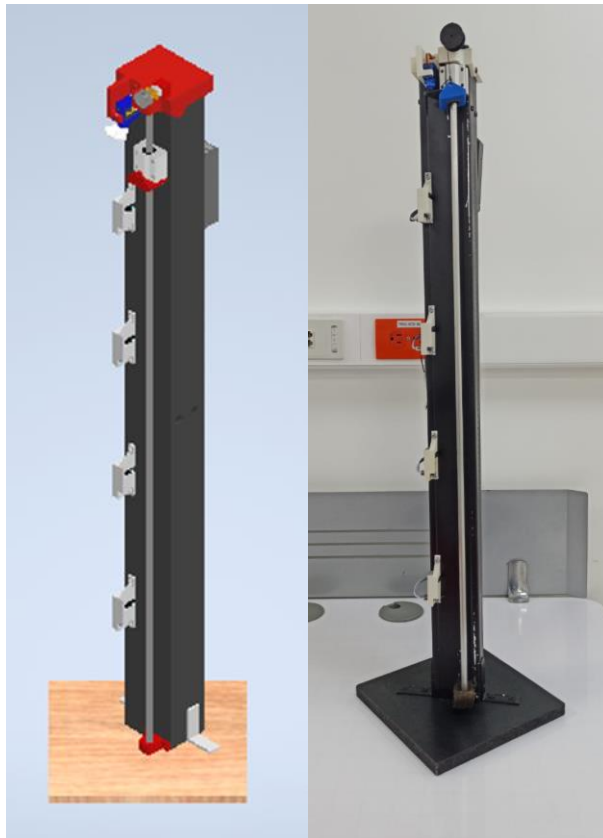
Figura 75. Comparación entre el diseño y la construcción del componente mecánico del módulo de caída libre
