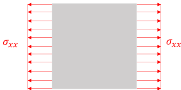
Figura A.4: Placa de dimensões unitárias sujeita a uma tensão de tração \sigma_{xx} .
