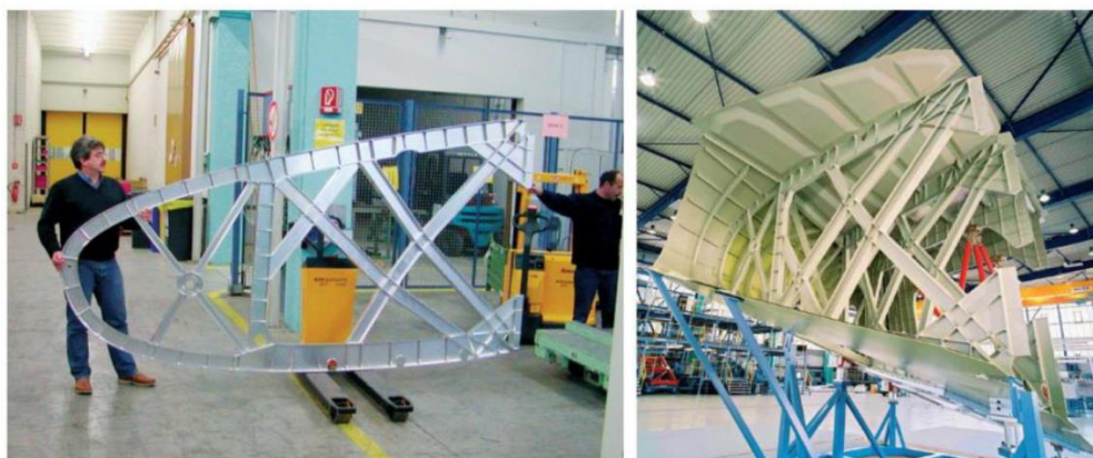
Figura 2.5: Nervuras do bordo de ataque e fuselagem interna de uma porta do Airbus A380. [114]
