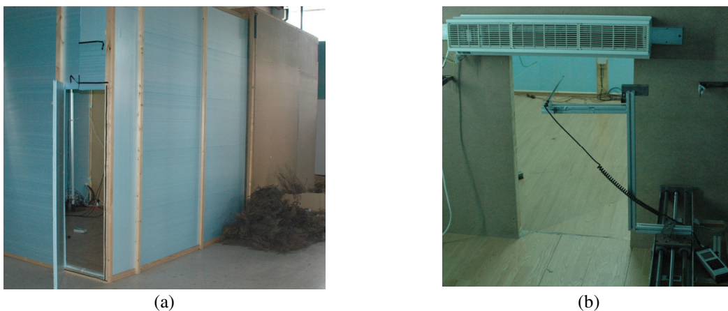
Fig.1. (a) Foto da instalação com os dois compartimentos; (b) Porta de ligação com dispositivo de cortina de ar
