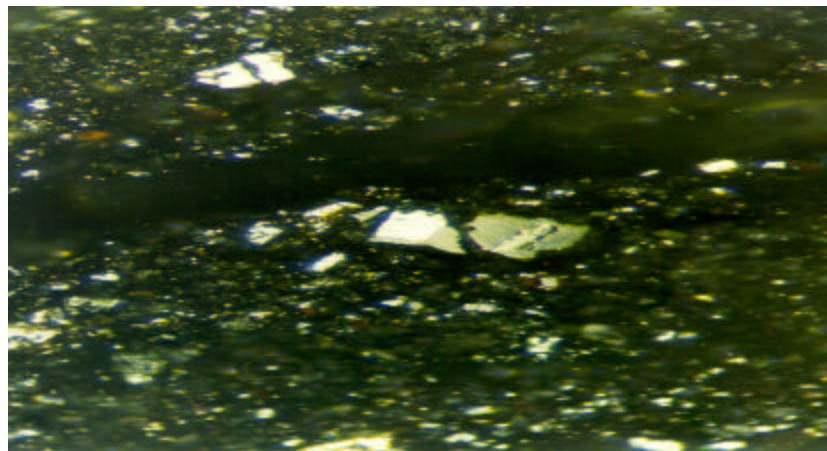
Figura 3.2 Fotomicrografía de la muestra del concentrado de galena.
