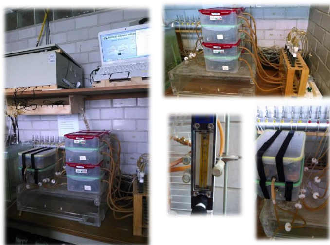
Figura 7.7.1. Instalación del respirómetro para la cuantificación de \text{CO}_2 .
