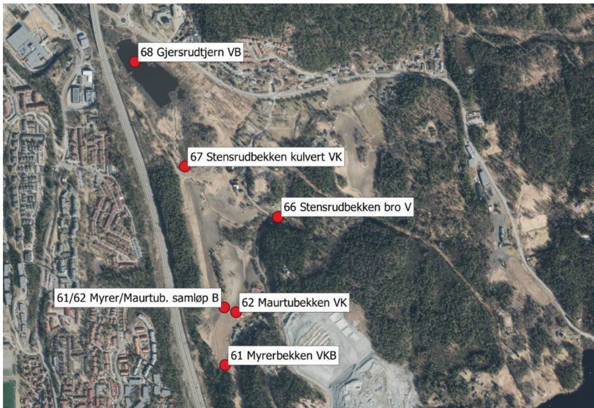
Figur 2. Overvåkingsstasjoner rundt anleggsområdet på Åsland for kontinuerlig overvåking og/eller vannprøvetaking og fisk- og bunndyrundersøkelser. V= Vannprøver. K= Kontinuerlige målinger. B= Biologiske undersøkelser.
