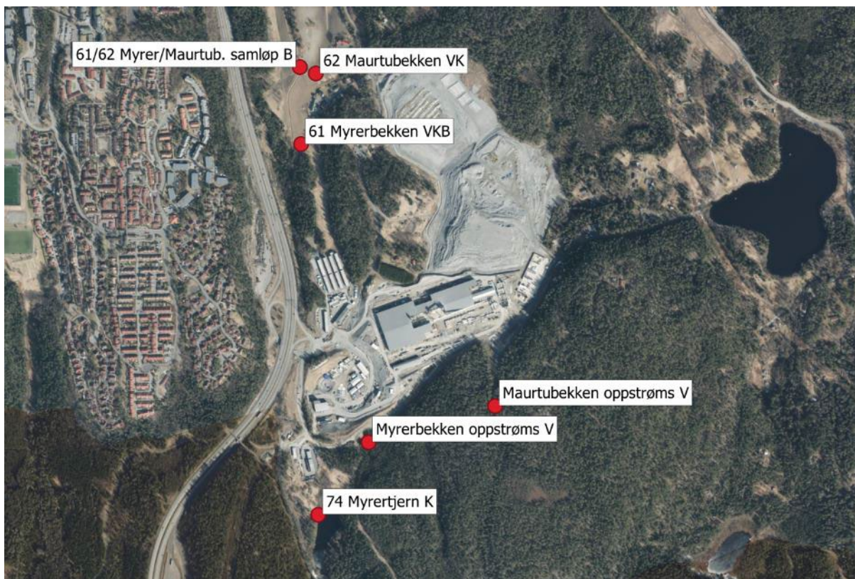
Figur 3. Overvåkingsstasjon i Myrertjern på sørsiden av Åsland. V= Vannprøver. K= Kontinuerlige målinger.
