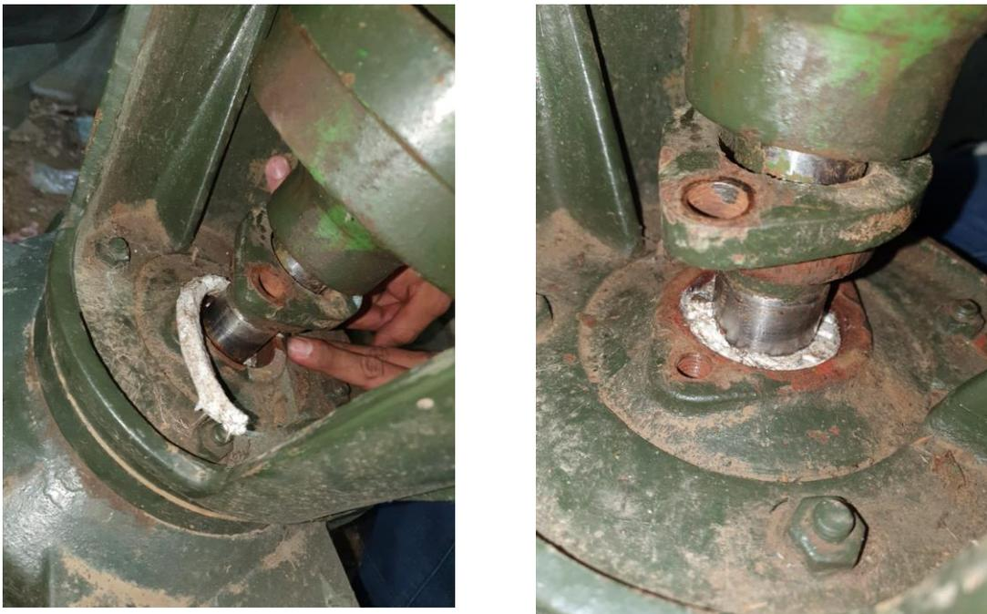
Figura 34. Instalación de empaquetadura de teflón
