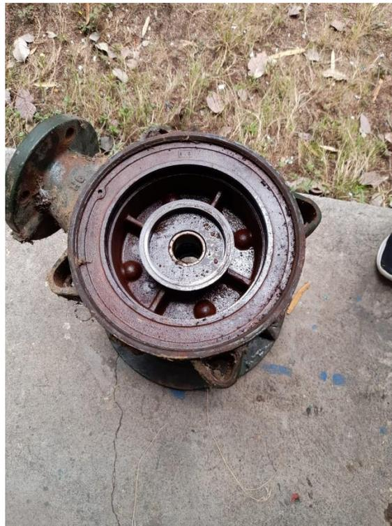
Figura 32. Tapa inferior con bushing de bronce donde va asentado eje de la bomba
