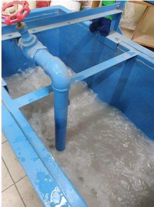
Figura 45: Descarga de agua de la bomba centrífuga en el banco de ensayo
