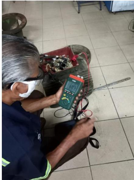
Figura 24. Experto realizando prueba Megger
