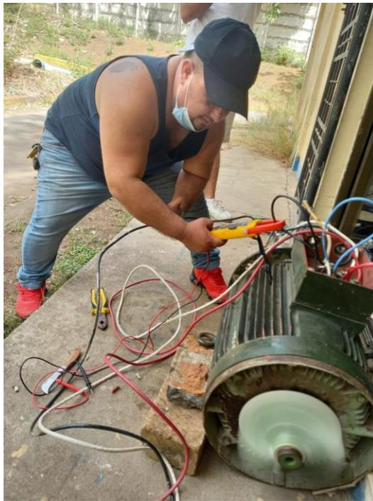
Figura 44 Comprobando arranque y giro del motor en vacío
