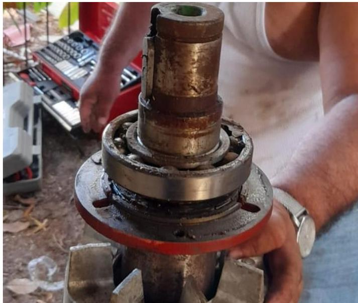
Figura 29. Balinera en mal estado por oxido
