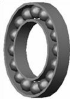
Figura 9. Cojinete de rodamiento
