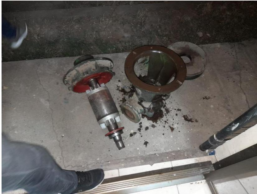
Figura 28. Rotor y tapa inferior
