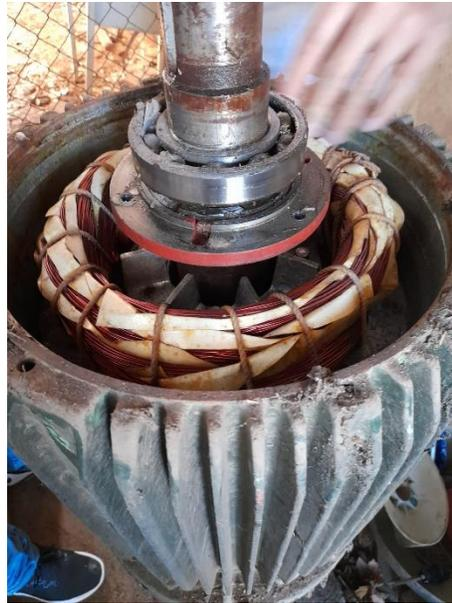
Figura 20. Motor sin tapa superior
