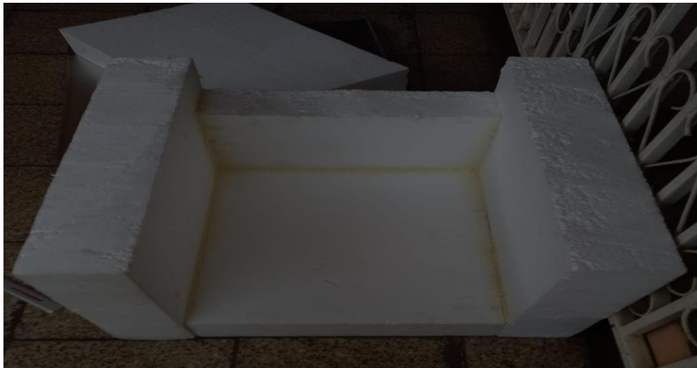
Figura 14. Elaboración de la cámara de medición en poliestireno expandido. (fuente propia)
