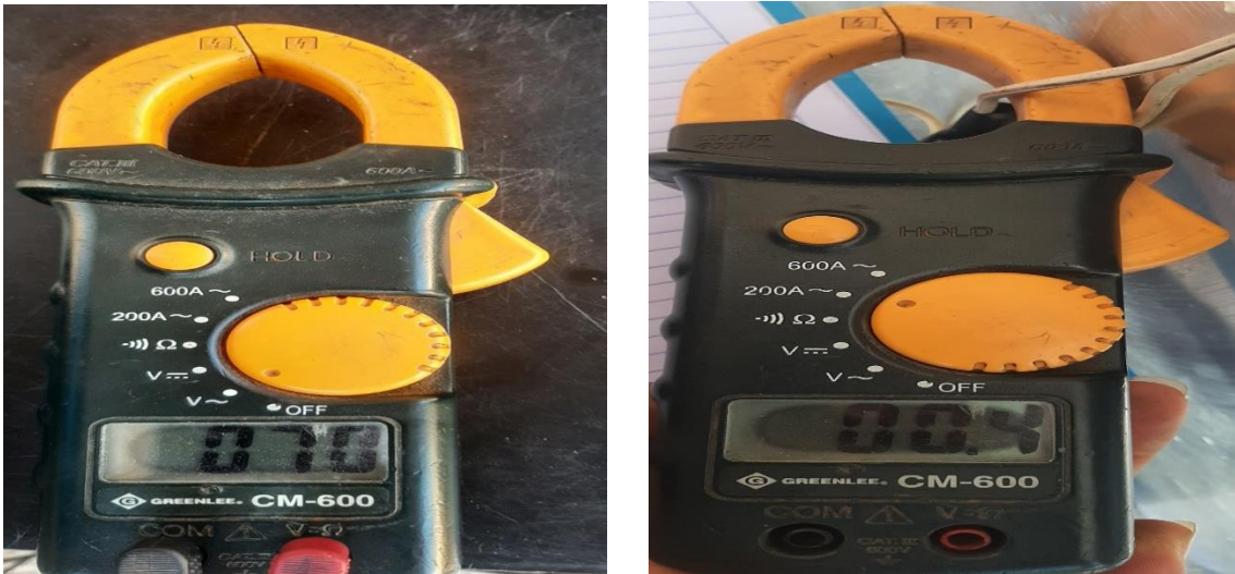
Figura 11. Medición de voltaje y corriente para las mediciones 1 de cada bloque. (fuente propia)
