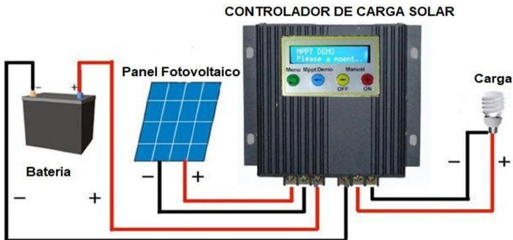
Ilustración 7 Controlador de Carga de un Sistema Solar Fotovoltaico
