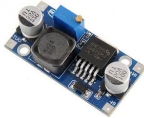
*Ilustración VIII.14. Estabilizador descendente DC-DC LM2596*
