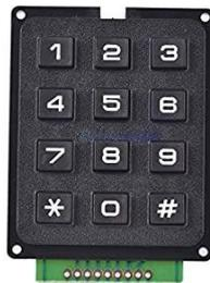
*Ilustración VIII.9. Keypad de membrana 4x3*
