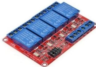
*Ilustración VIII.13. Módulo relay 4 canales*
