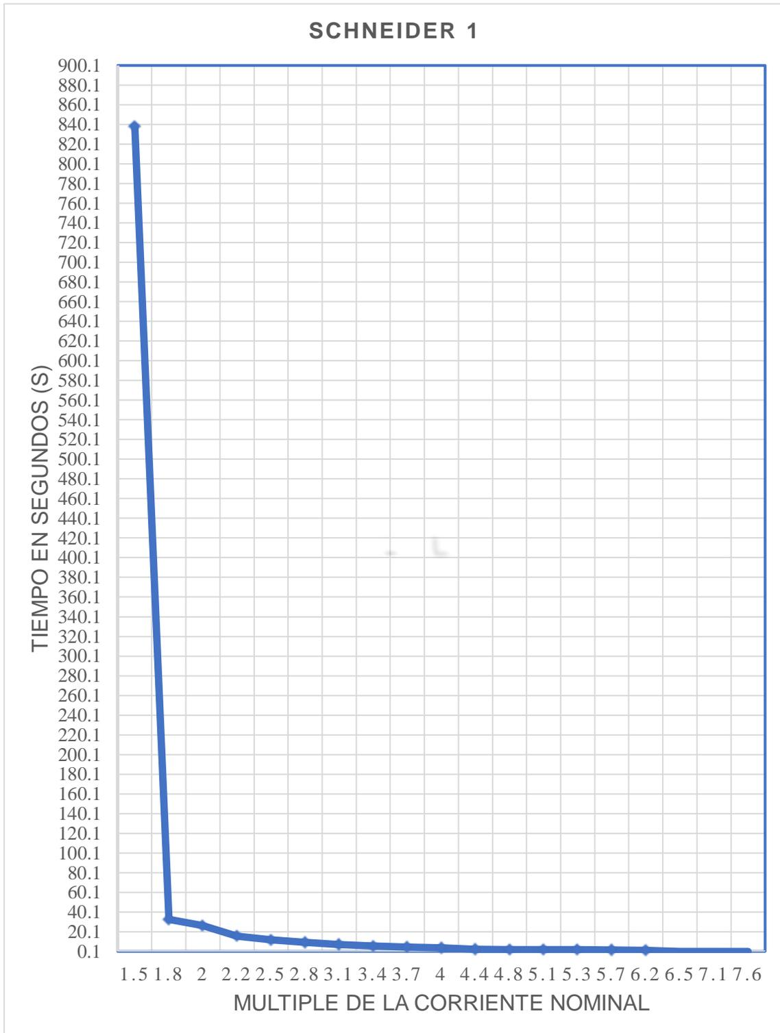
**Figura 34: Diagrama de flujo Tiempo-Múltiplo de la corriente nominal SCHNEIDER 1**
