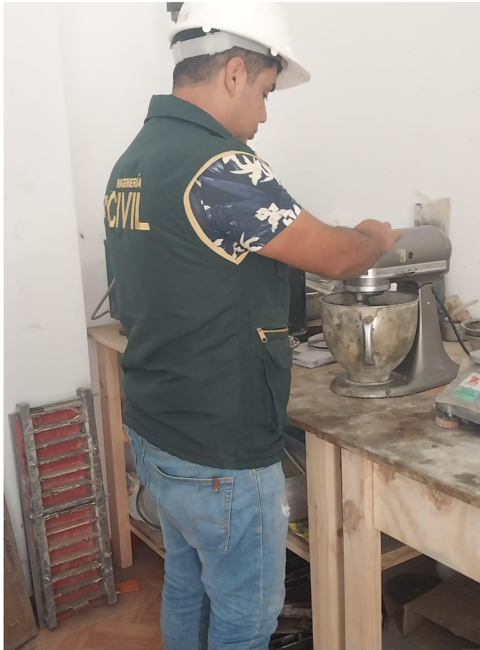
Fig. 28. Preparación de Mortero.
