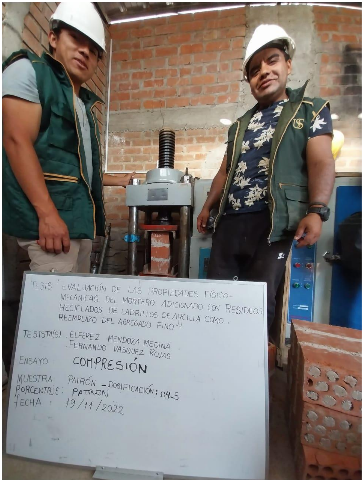
Fig. 33. Prisma ensayando a resistencia a compresión axial.
