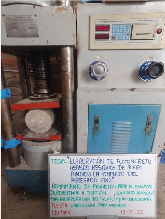
Fig. 29. Ensayo tracción probetas 280 kg/cm<sup>2</sup> – 28 días
