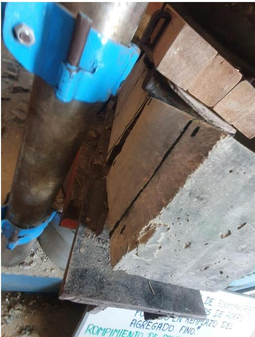
Fig. 30. Ensayo tracción vigas 210 kg/cm<sup>2</sup> – 14 días
