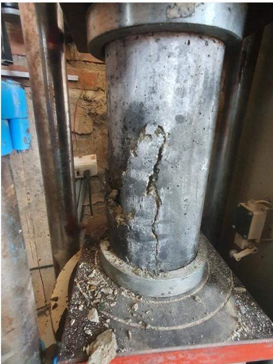
Fig. 28. Ensayo compresión probetas 280 kg/cm<sup>2</sup> – 14 días
