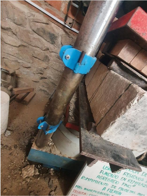
Fig. 27. Ensayo tracción vigas 210 kg/cm<sup>2</sup>
