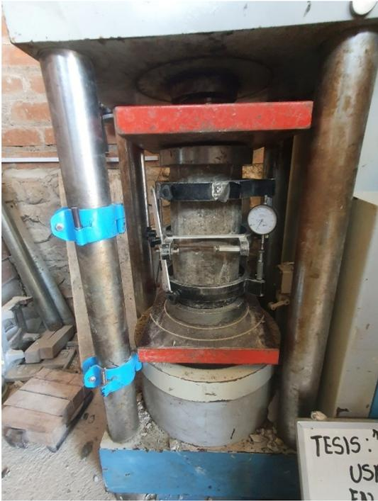
Fig. 21. *Ensayo compresión probetas 280 kg/cm<sup>2</sup> – 28 días*
