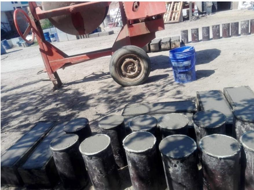
Fig. 18. *Secado de probetas*
