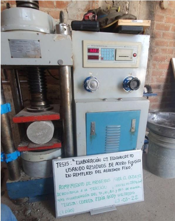
Fig. 23. *Ensayo tracción probetas 280 kg/cm<sup>2</sup> – 7 días*
