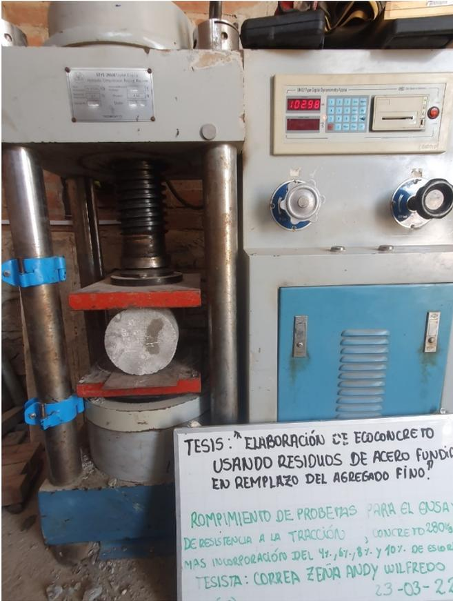
Fig. 25. *Ensayo tracción probetas 280 kg/cm<sup>2</sup> –28 días*
