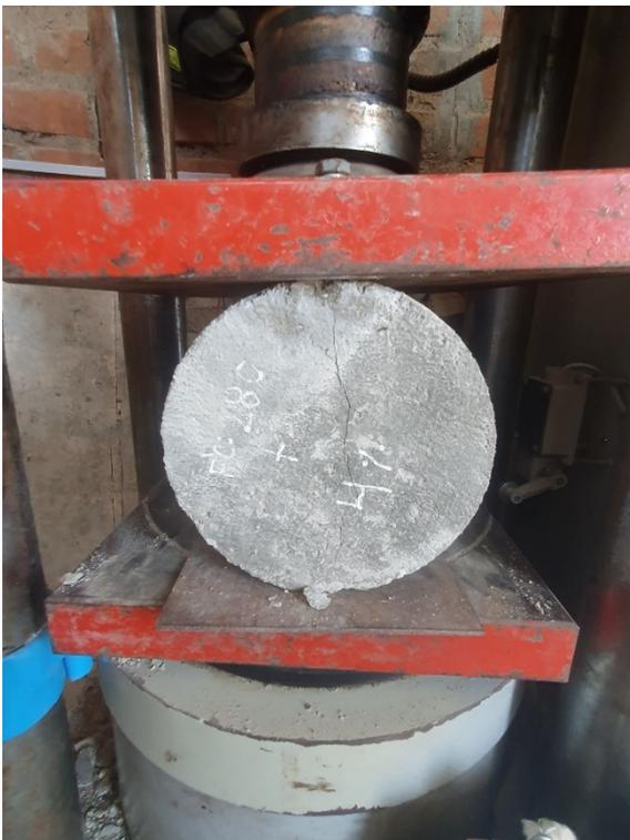
Fig. 22. *Ensayo tracción probetas 280 kg/cm<sup>2</sup> – 14 días*
