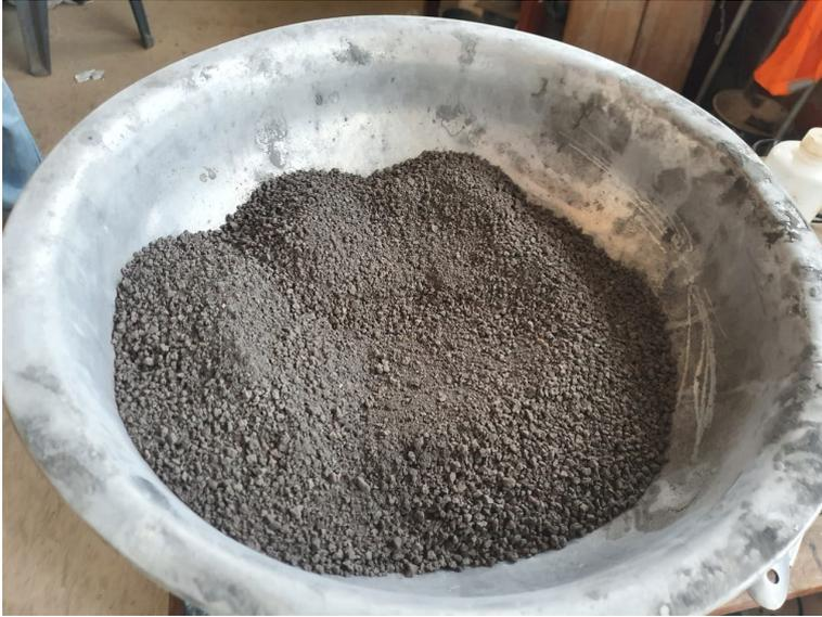
Fig. 13. *Residuos de fibra de acero*
