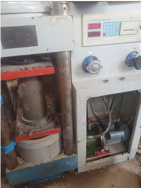
Fig. 32. *Ensayo tracción probetas 210 kg/cm<sup>2</sup> – 14 días*
