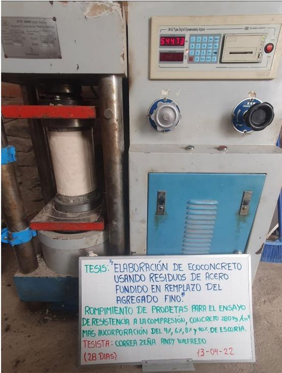
Fig. 33. *Ensayo compresión probetas 280 kg/cm<sup>2</sup> – 28 días*
