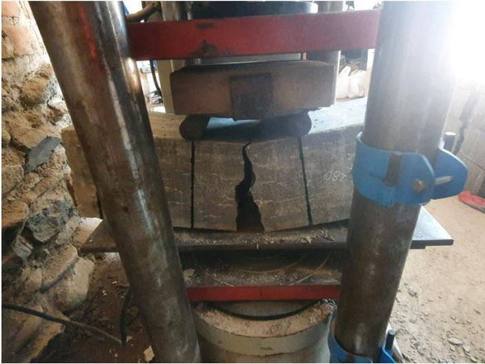
Fig. 31. *Ensayo tracción vigas 210 kg/cm<sup>2</sup> – 28 días*
