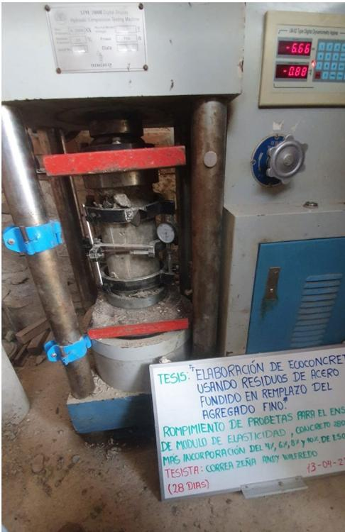
Fig. 34. *Ensayo módulo de elasticidad probetas 280 kg/cm<sup>2</sup> – 28 días*
