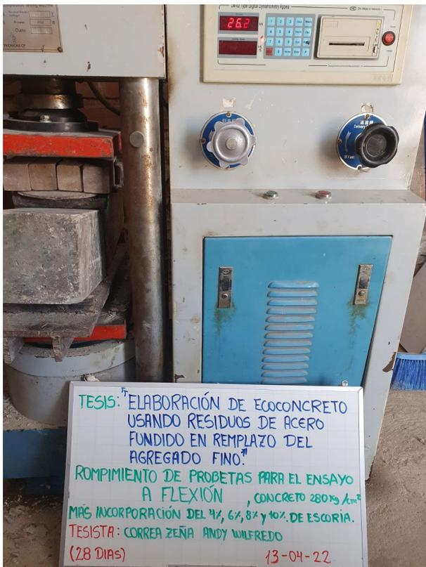
Fig. 20. *Ensayo flexión probetas 280 kg/cm<sup>2</sup> – 28 días*
