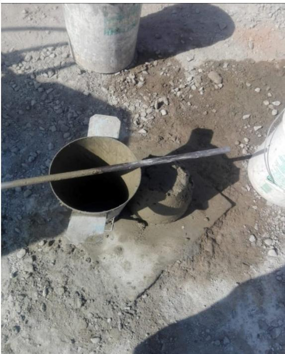
Fig. 16. *Slump mezcla de concreto*
