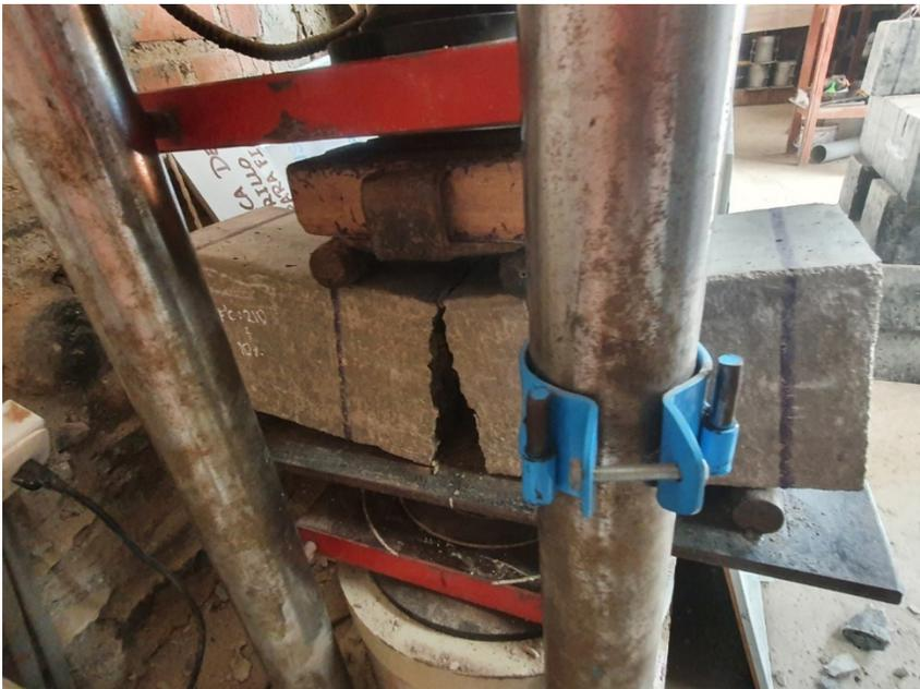
Fig. 26. *Ensayo tracción vigas 280 kg/cm<sup>2</sup>*
