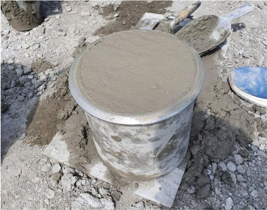
Fig. 17. *Peso unitario mezcla de concreto*
