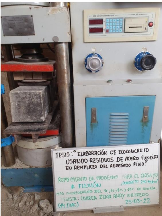
Fig. 24. *Ensayo tracción probetas 210 kg/cm<sup>2</sup> – 14 días*
