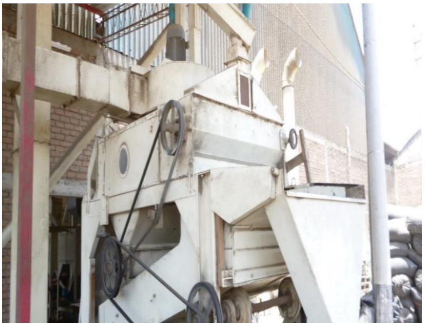
Figura 62. Pre limpia Fuente: Elaboración propia
