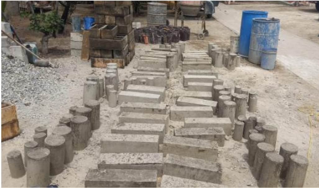
Fig. 34. Desencofrado de muestras.
