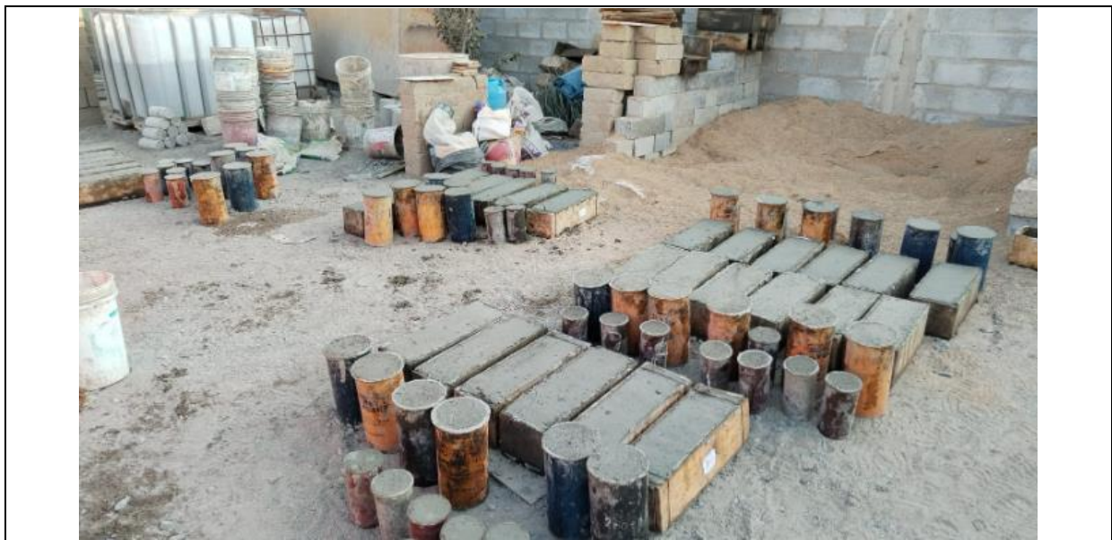
Fig. 33. Realización de probetas y vigas
