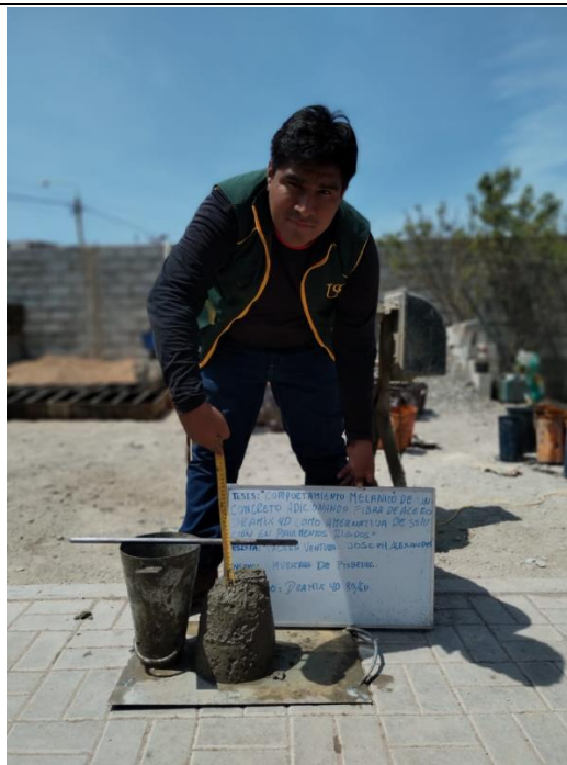
Fig. 27. Ensayo de Asentamiento para el concreto patrón y dosificado con fibra de acero Dramix 4D
