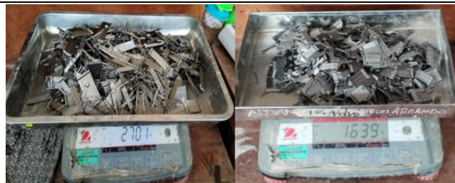
Fig. 18. Fibras de acero Dramix 65/60 y 80/60
