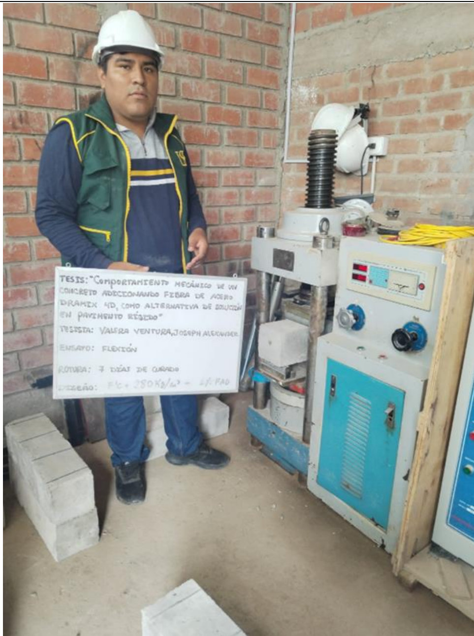
Fig. 40. Ensayo de Resistencia a flexión para el concreto patrón y dosificado con fibras Dramix 4D
