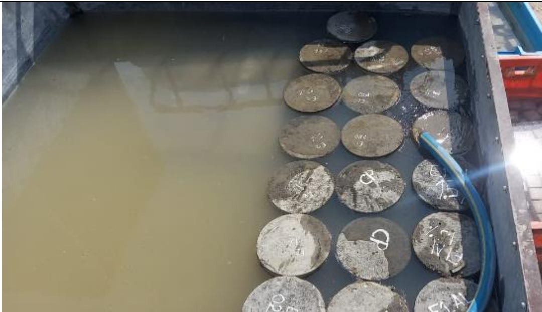
Fig. 35. Curado de probetas
