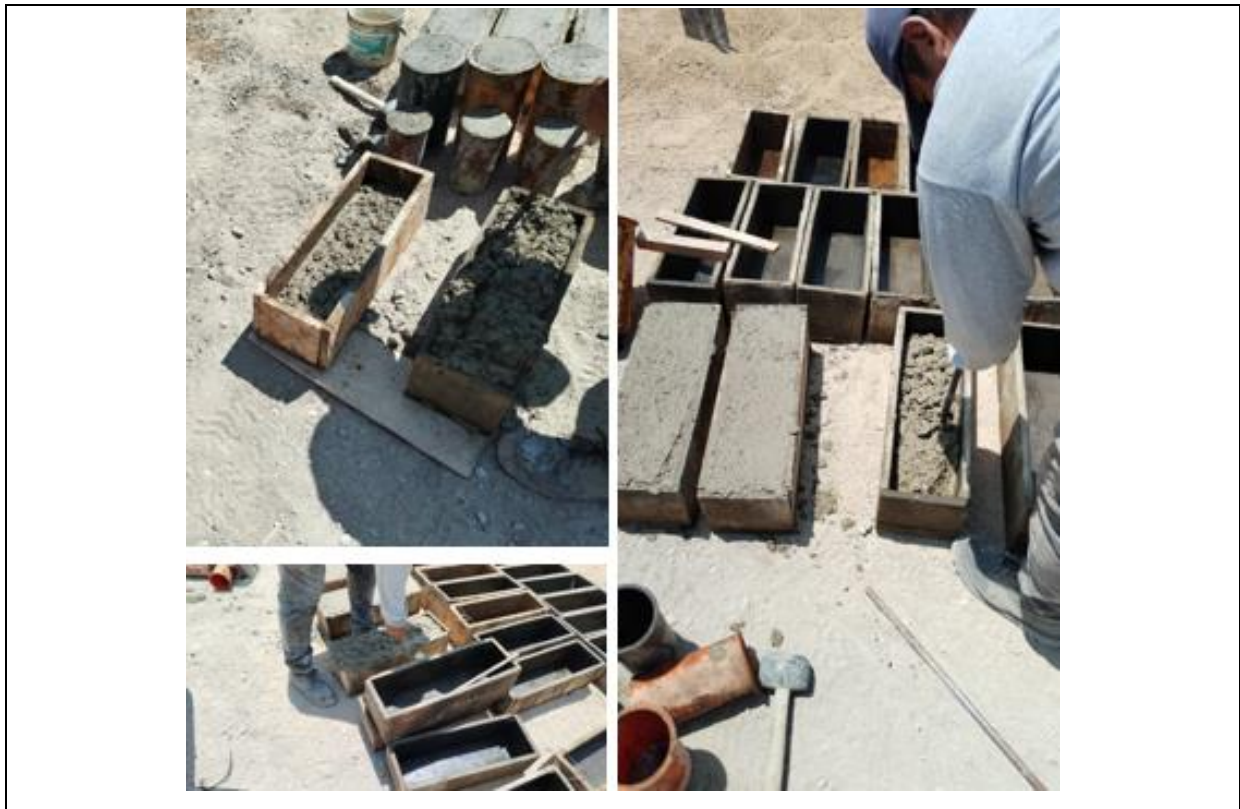
Fig. 32. Vaciado y chuseado de la mezcla de concreto hacia las muestras
