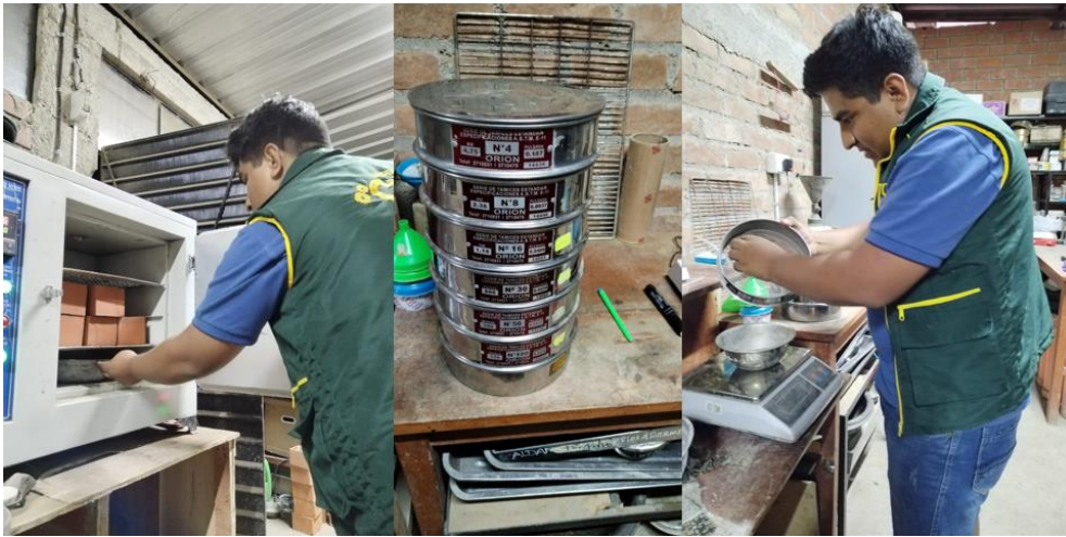
Fig. 19. Tamizado de los agregados y pesado del material retenido
