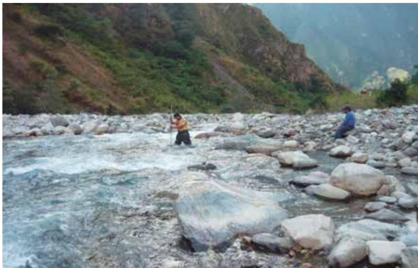
**Foto 3.2** Aforo por vadeo en río Aobamba (08/07/2010),  $Q = 3,9 \text{ m}^3/\text{s}$ . **Fuente:** Senamhi
