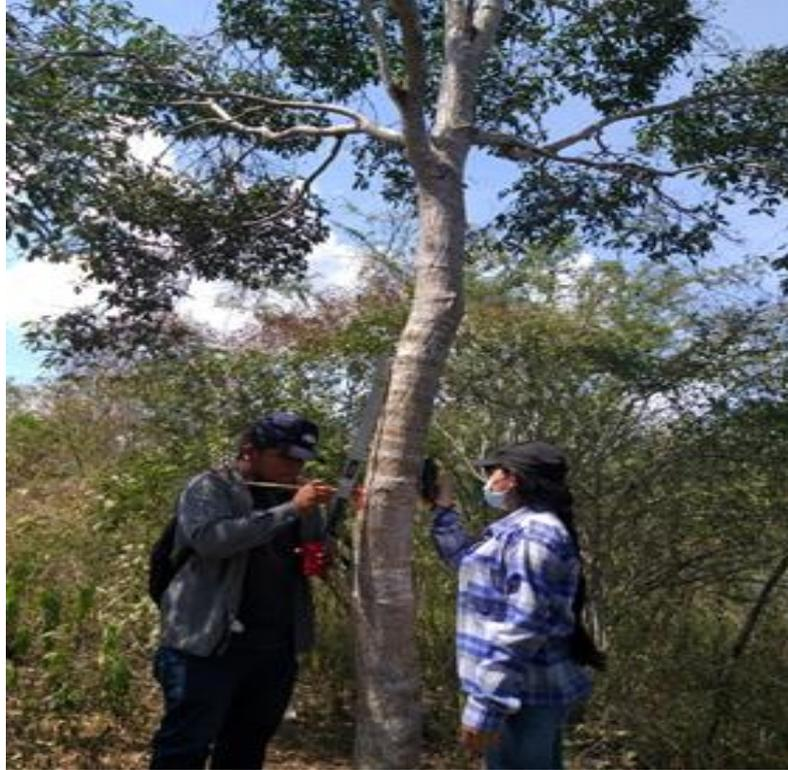
Medición de Circunferencia a la Altura del Pecho con el empleo de una cinta métrica
