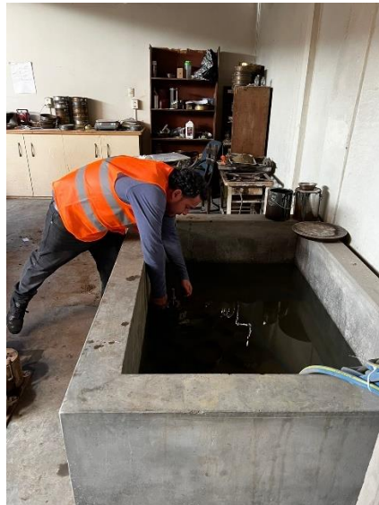
Figura 12. Proceso de curado de probetas con aditivos químicos Fuente: Elaboración propia
