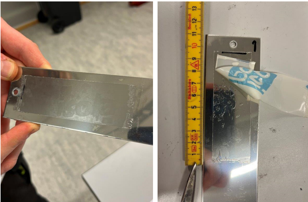
Figur 3.9. Eksempler som viser at trykk på bæreren har innvirkning på limets egenskaper etter aldring. Foto: Susanne Frank, SINTEF Community
