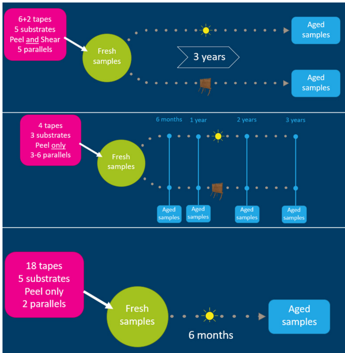
Figur 3.5. Forenklet framstilling av det eksperimentelle oppsettet for naturlig aldring i TightEN, hvor "sol" symboliserer aldring foran kledning (eksponert for vær og vind), mens "kledningspaneler" symboliserer aldring bak kledning.
