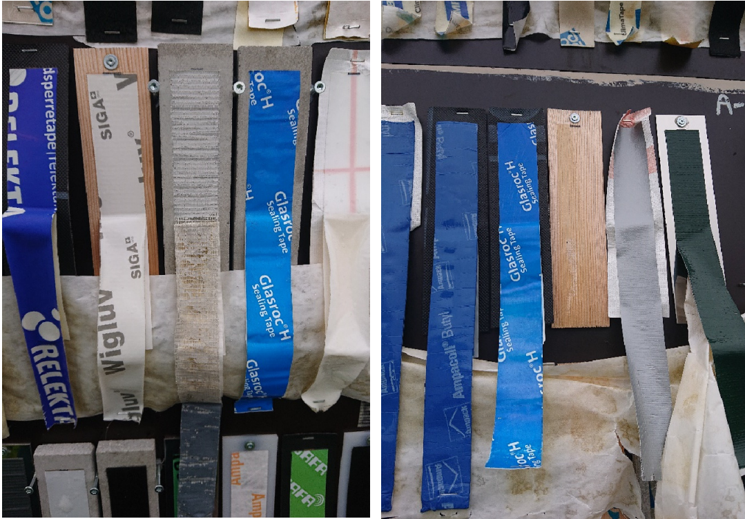
Figur 3.8. Etter fire måneders eksponering falt teip som ikke beregnet til byggformål, av, mens alle byggteiper fremdeles var klebet til sine respektive substrater. Foto: Malin Sletnes, SINTEF Community
