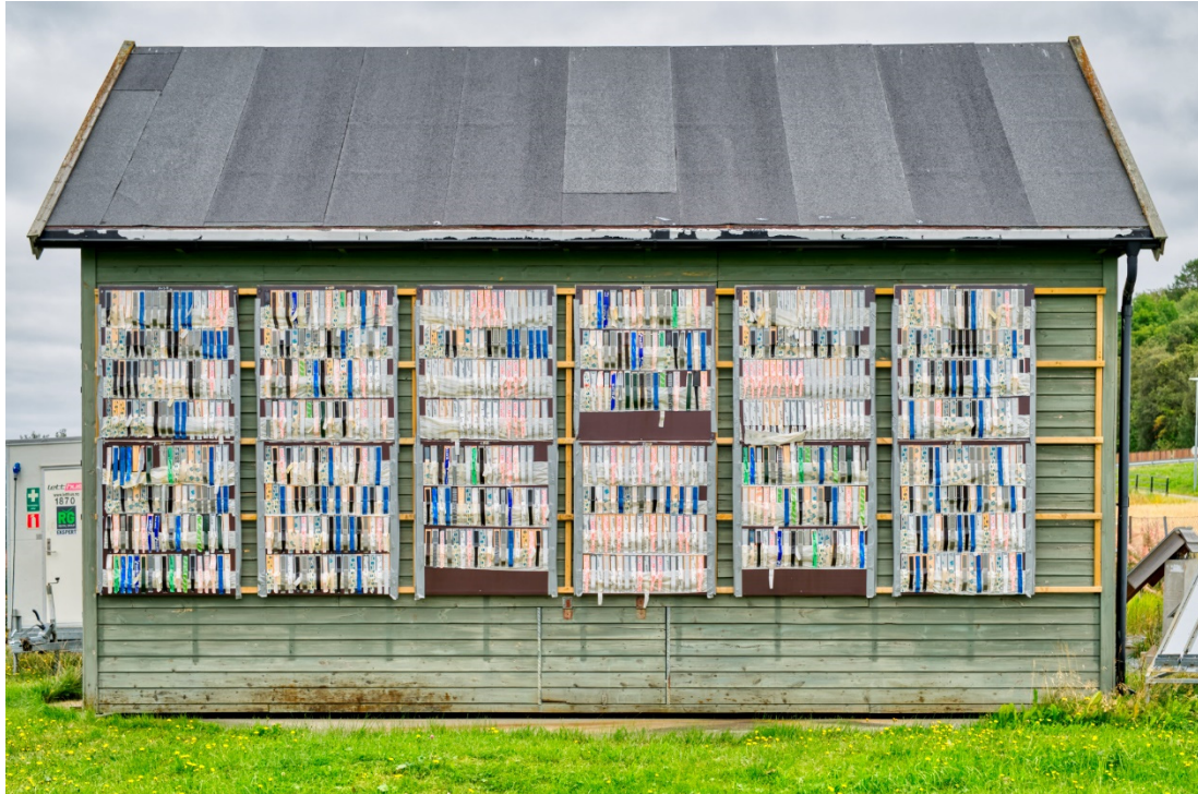
Figur 3.6. Utendørs eksponering av teip for naturlig aldring i TightEN-prosjektet. Foto: Nicola Lolli, SINTEF Community.
