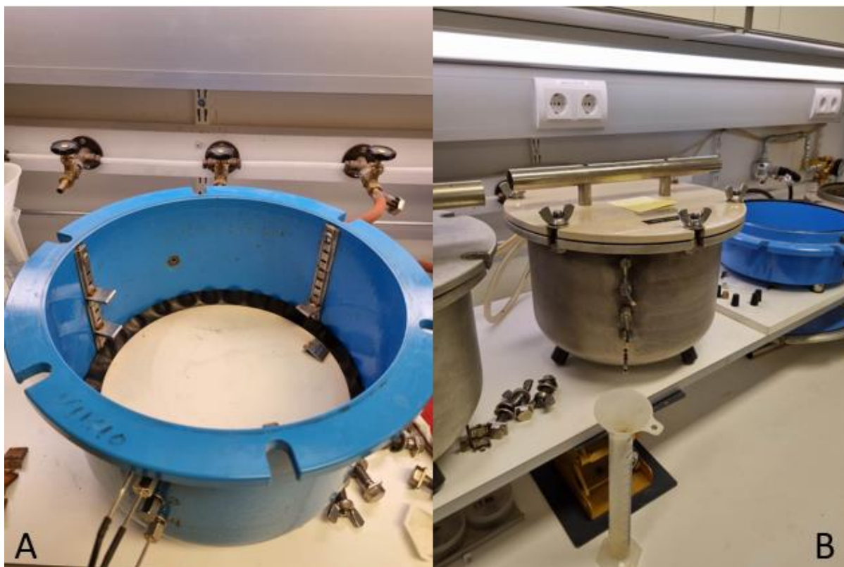
Figur 12: Figur A viser oppi trykkammeret der prøvene skal være plassert. Bilde B viser hvordan det ser ut når målingen er i gang der vannet drypper ut av de små rørene og opp i sylindere på siden av. Foto: Torvald Rosseland
