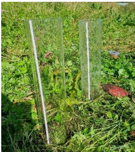
Figur 9: Oppsett av MPD (Modified-Philip Dunne) forsøk med to sylindere. Målebåndene på siden av sylindrene brukes for å måle vannstand. Foto: Torvald Rosseland
