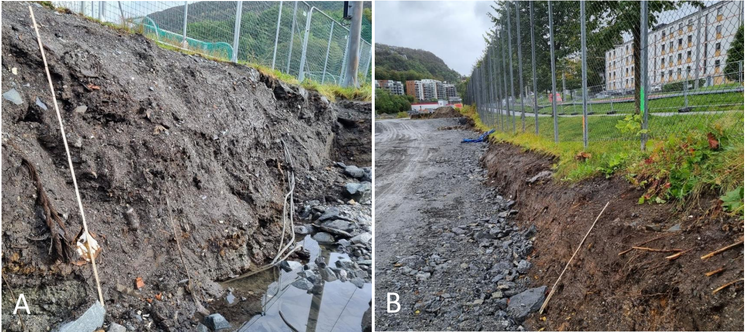
Figur 10: Vertikal profil ved Linje 2 (A) der en kan se avfallsmasser blandet med jord og grus. Profil ved Linje 4 (B) der jordprøver ble tatt, også her var det mulig å se avfallsmasser. Foto: Torvald Rosseland.
