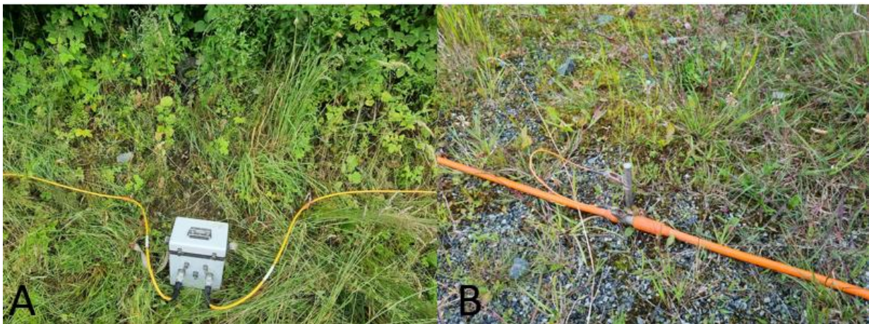
Figur 7: Bilde A viser Syscalen og bilde B viser en elektrode som er festet med en krokodilleklips til kabelen. Foto: Torvald Rosseland
