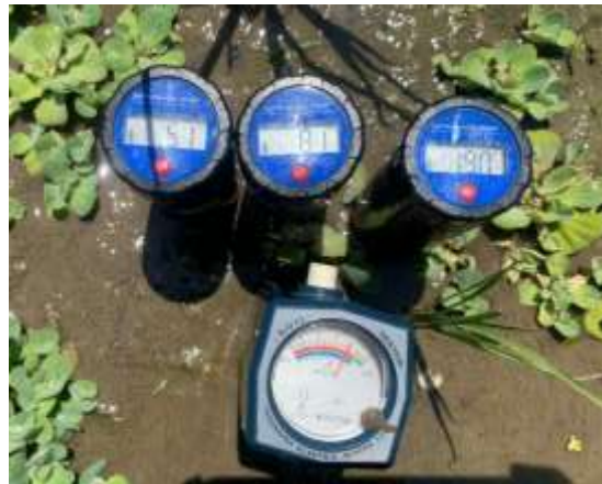
Gambar 4. Sensor NPK, kelembaban, dan pH tanah.
