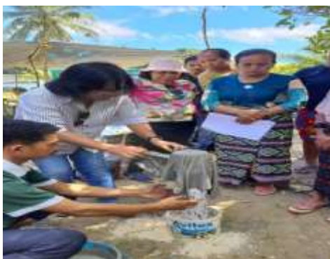
Gambar 5. Proses pembuatan pot handuk semen.
