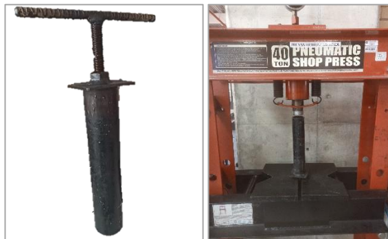
Fig. 7. Moldaje para la elaboración de briquetas Fuente: Autor
