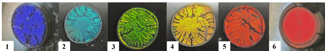
Рис. 1. Оптические фотографии фотонных коллоидных кристаллов (ФКК) из микросфер полистирола различных диаметров: (1) 180 нм, (2) 200 нм, (3) 220 нм, (4) 230 нм, (5) 240 нм, (6) 260 нм.
