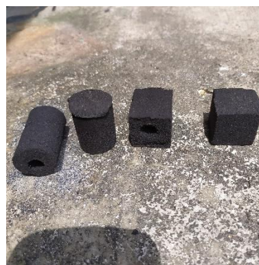
Gambar 1. Bentuk briket sampah serbuk kayu silinder berongga, silinder pejal, kubus berongga, dan kubus pejal (kiri ke kanan).
